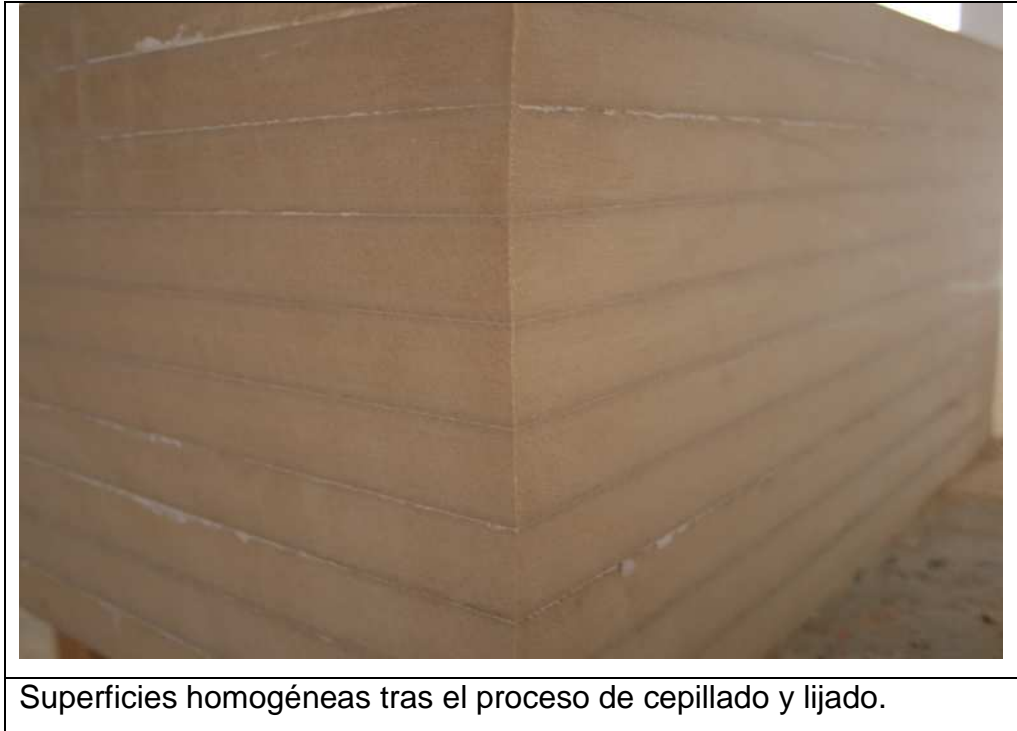
Figura 80. Elaboración propia (2012). Superficie homogénea libre de astillado, desfibrado o principio de separación de piezas.
