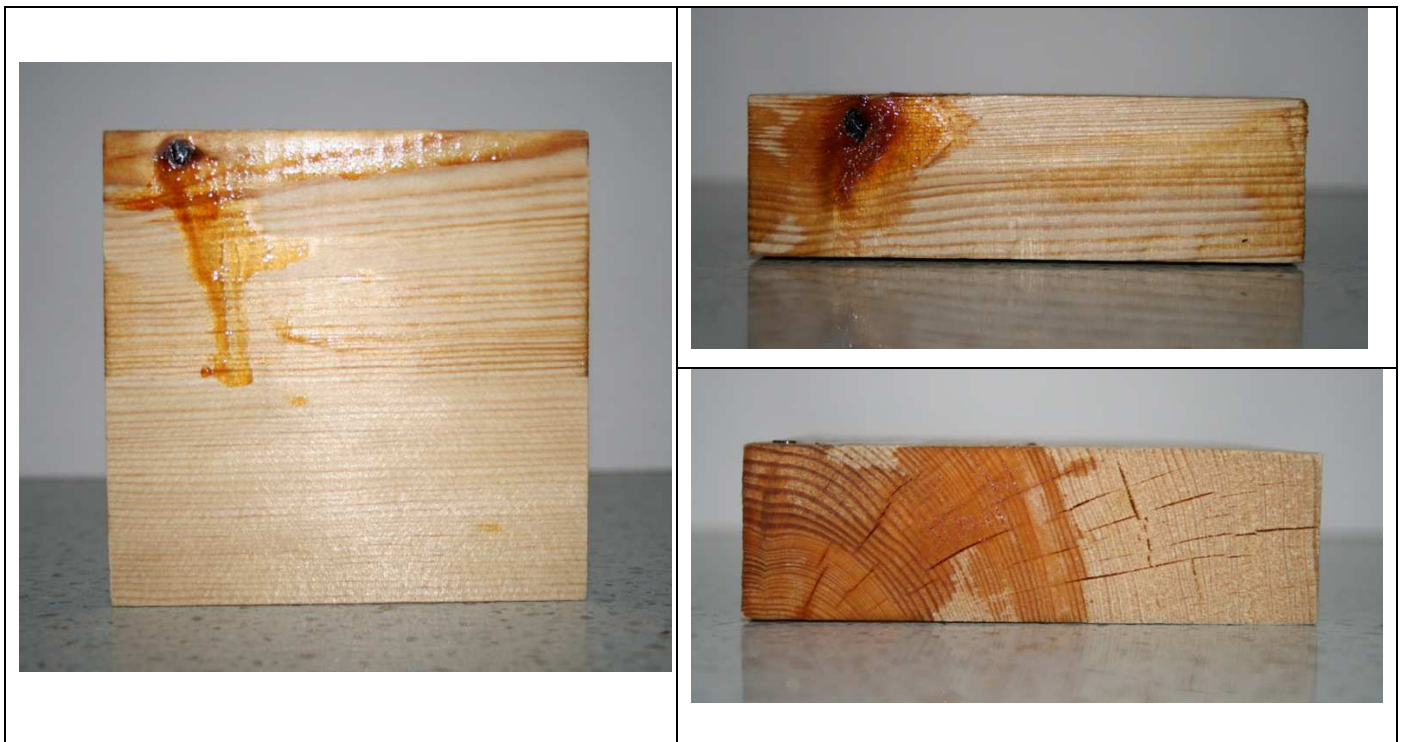
Figura 17. Elaboración propia (2012). Disminución de grietas y exudación de resina.
