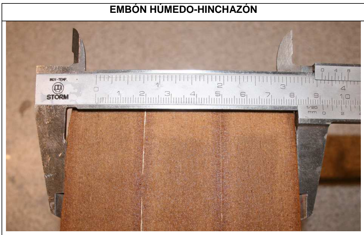
Figura 26. Imagen de elaboración propia (2012). Efecto de hinchazón por causa de la humedad.
