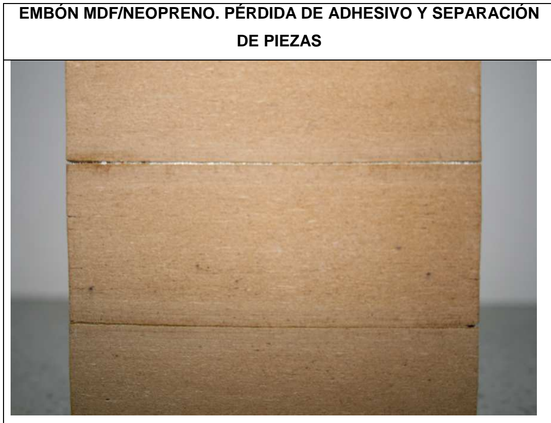
Figura 29. Elaboración propia (2012). Principio de separación de piezas.
