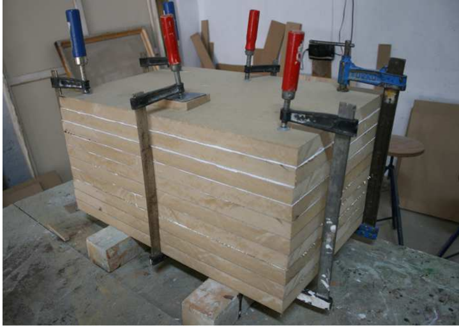
Sujeción y presión por medio de sargentos hasta el curado total del adhesivo.
