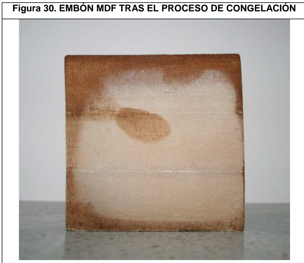
Figura30. Elaboración propia (2012). Embón de MDF tras el proceso de congelación.
