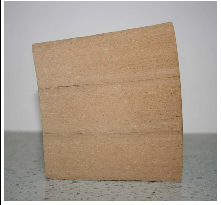
Figura 27. Elaboración propia (2012). Deformación volumétrica por la acción del calor.
