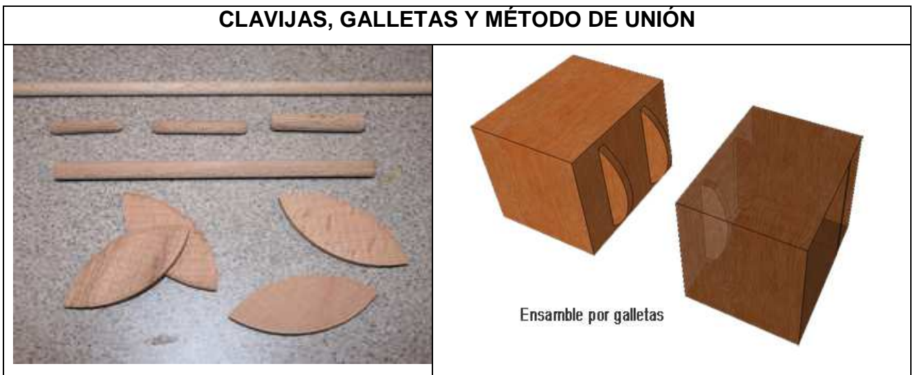
Figura 8. Imágenes de elaboración propia (2012). Clavijas, galletas y método de unión.
