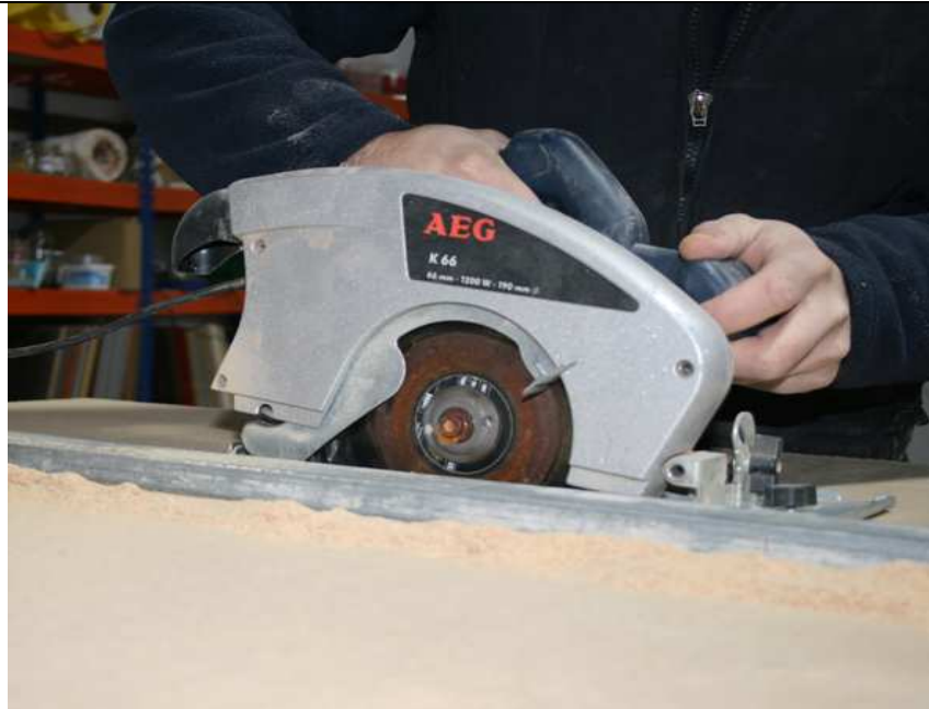
Corte mecánico de las partes que configurarán el embón.
