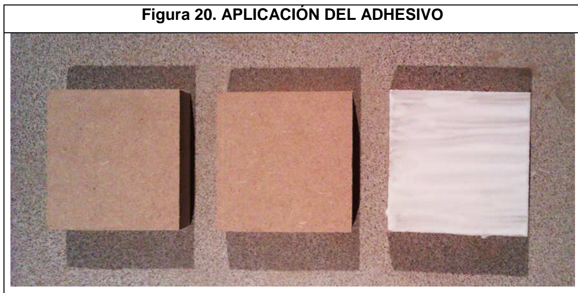
Figura 20. Elaboración propia (2012). Aplicación del adhesivo.
