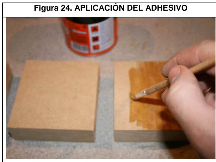
Figura 24. Elaboración propia (2012). Aplicación del adhesivo.
