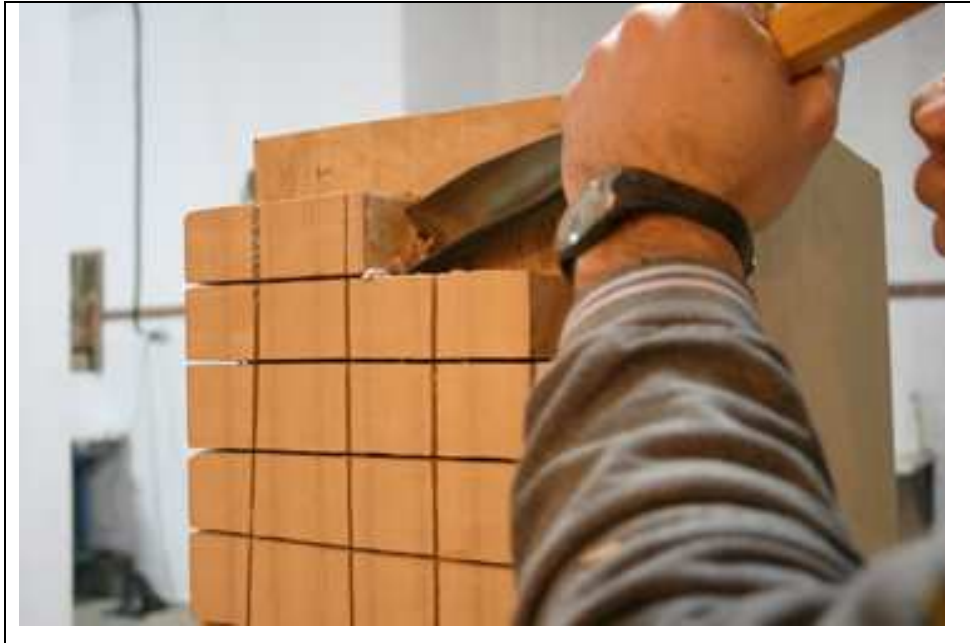
Figura 85. Elaboración propia. Desbaste mediante cortes paralelos y perpendiculares en el embón.
