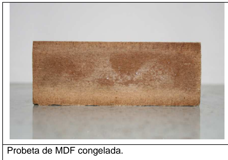
Figura 18. Elaboración propia (2012). Congelación de probeta MDF tras saturación de humedad.
