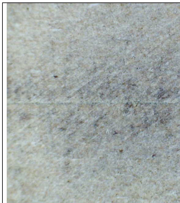
20x. Embón por medio de adhesivo en base de neopreno: junta de unión
