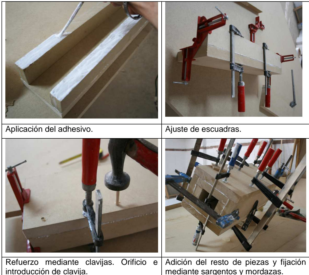
Figura 114. Elaboración propia (2012). Construcción del embón hueco.
