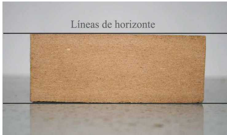
Figura 12. Elaboración propia (2012). Véase la deformación de la probeta.
