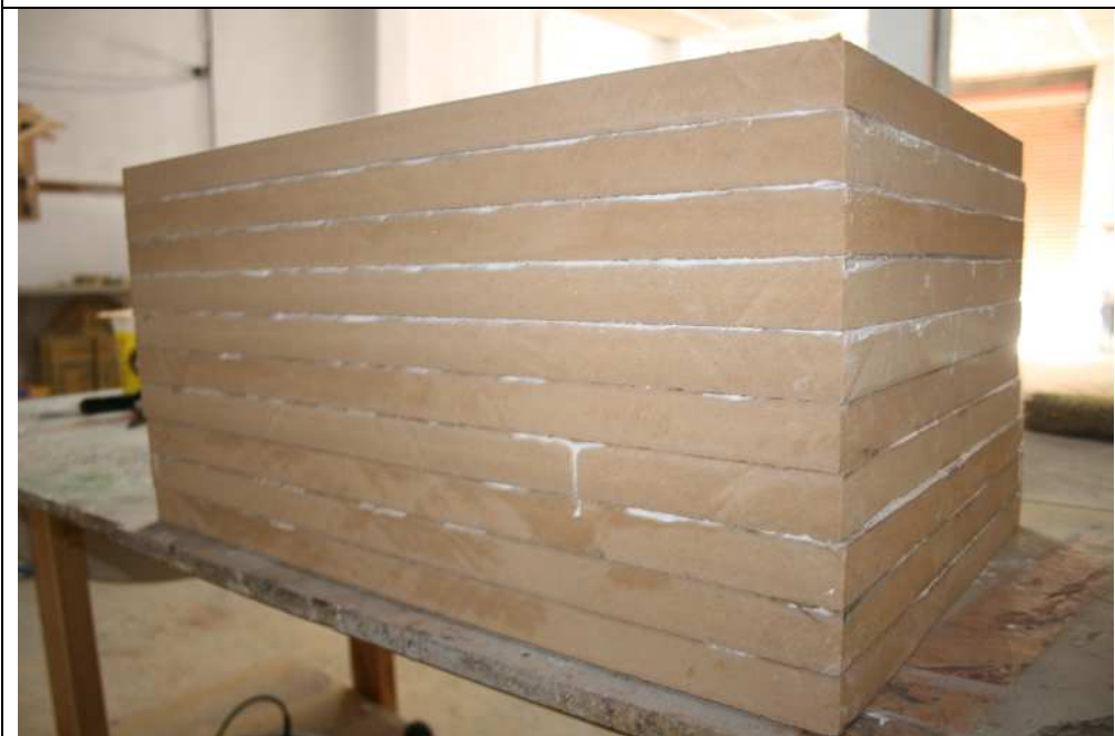
Superposición de las diferentes piezas que forman el embón. Véase el adhesivo sobrante tras el frotamiento de las piezas.
