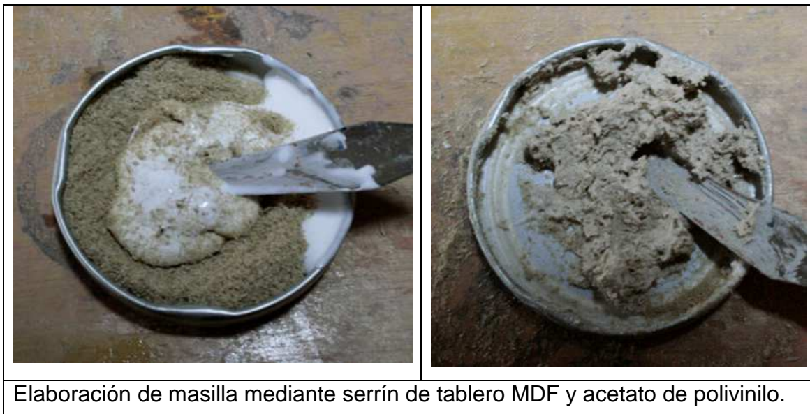
Figura 126. Elaboración propia (2012). Elaboración de masilla.
