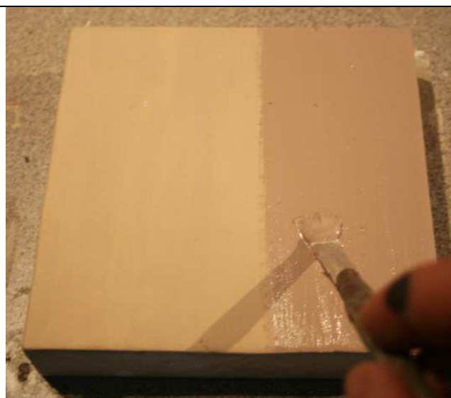
FIGURA 59. APLICACIÓN DE SEGUNDA CAPA DE ÓLEO Y MATIZ DE COLOR
