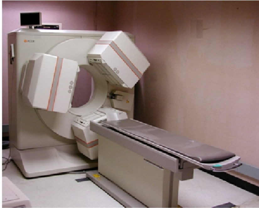
Figura 1.1: Gamma Cámara Picker Prism 3000
