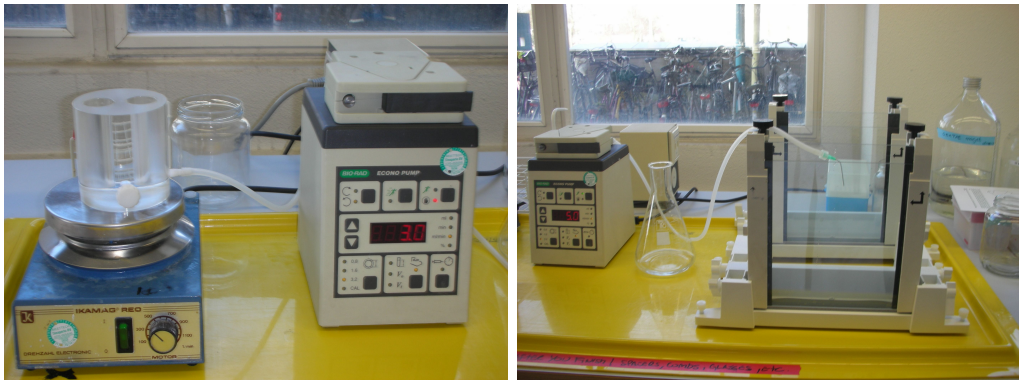
Figura IV.9. Bomba peristáltica y cubeta generadora de gradientes (Econopump; BioRad Laboratorios, Hercules, California).
