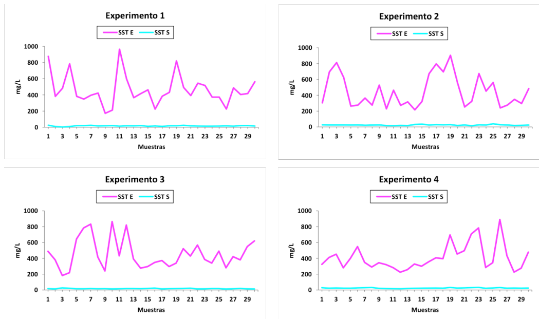
Figura II.11. Concentración de SST (mg/L) en el influente y en el efluente en los 4 experimentos.
