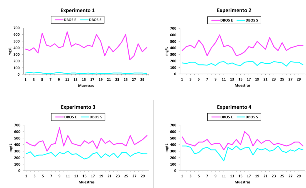
Figura II.8. Concentración de DBO 5 (mg O 2 /L) en el influente y en el efluente en los 4 experimentos.
