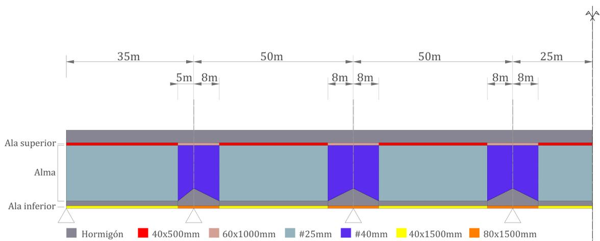
Figura 4.8: Guitarra de predimensionamiento de la estructura metálica. Iteración 1.
