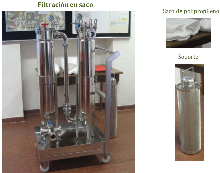
Figura 21. Sistema de filtración en saco.
