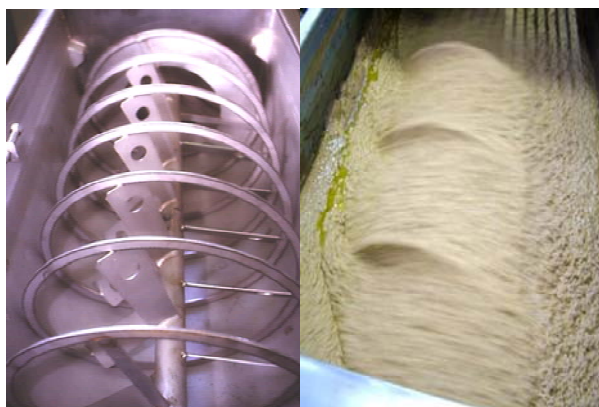
Figura 12. Detalle interior de una batidora horizontal. Hélice con las paletas para llevar a cabo el batido (izquierda) y pasta sometida a esta operación donde se pueden apreciar las islas de aceite (derecha).
