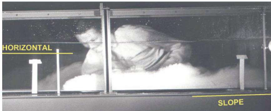
Figura 7. Tanque de experimentación para simulación de corrientes de turbidez (Posamentier y Walker, 2006).
