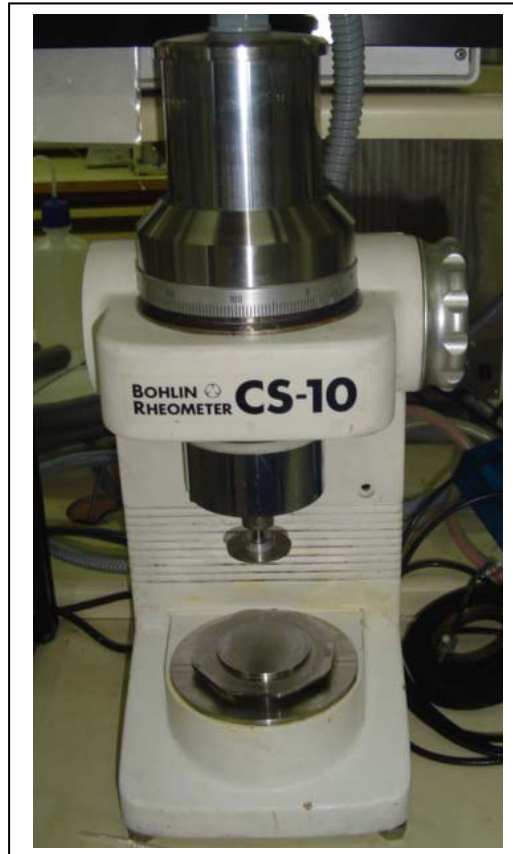
Figura 7. Reómetro de esfuerzo controlado usando una geometría de medida plato-plato.
