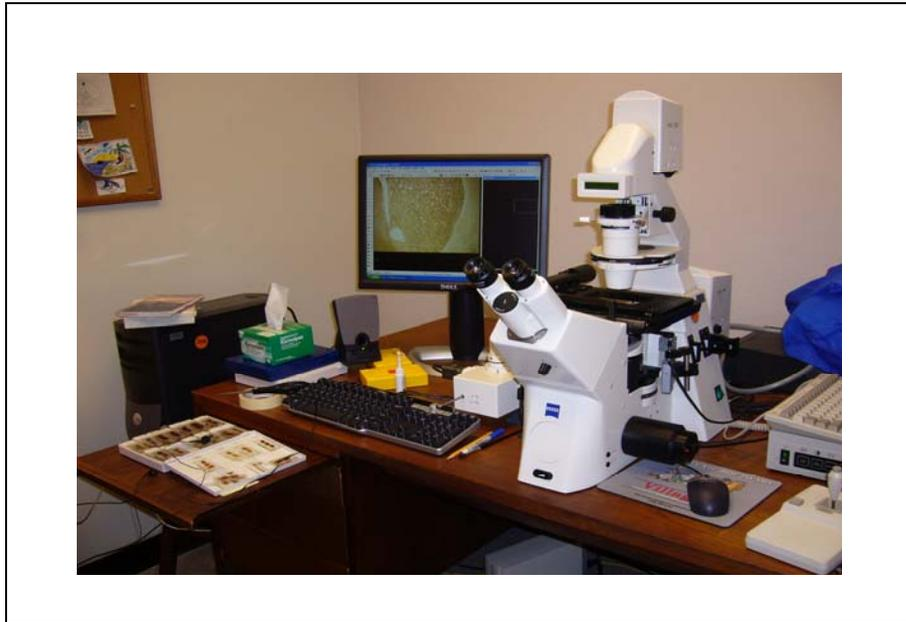
**Figura 4.1.-** Equipo para realizar la estereología, con el programa “Stereoinvestigador”, y el microscopio Axiovert Zeiss.
