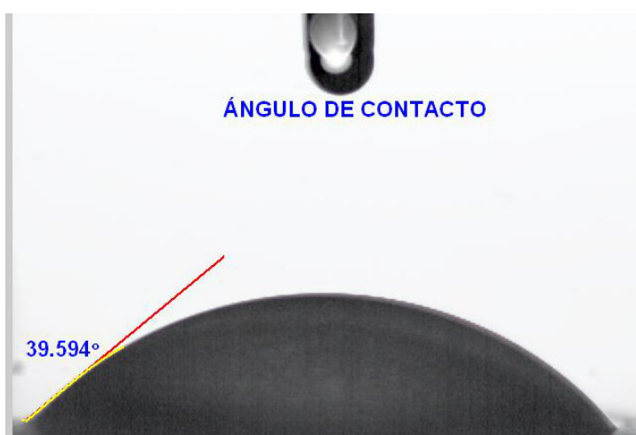
Figura 24. Ejemplo de determinación de ángulo de contacto. Parte superior: fotografía de gota depositada; parte inferior: ajuste del perfil de la gota y evaluación del ángulo.
