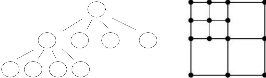
Finalmente cada nodo hoja del *quad tree* corresponderá a una región  $R_i$  (con  $i = 1 \dots n$ ). El árbol se construye dada una instancia de BRDF y conociendo la normal en un punto, y la dirección incidente sobre este. Asociado a éste, existirán otras clases, como son:
