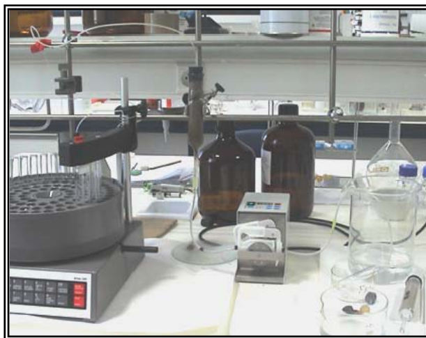
Figura 3.32 - Vista del montaje utilizado para la realización de las experiencias en columna.
