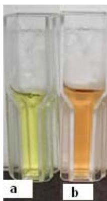
Figura 31. Reacción colorimétrica de producción de sideróforos de tipo hidroxamato, (a) negativo, (b) positivo
