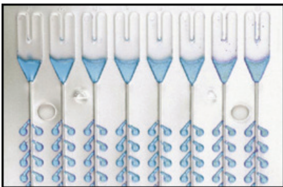
Figura 20. Detalle de los reservorios y pocillos de una tarjeta microfluídica.
