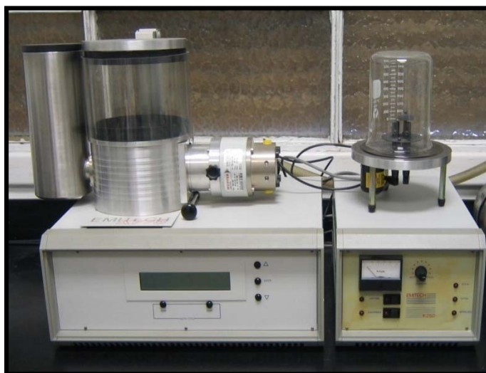
Figura 21. Criodesecador utilizado para el procesamiento de las células analizadas en esta Tesis Doctoral.
