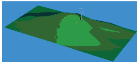
Figura 19: Colocación de un aerogenerador para aprovechar el efecto colina. Fuente: IDAE(2004).
