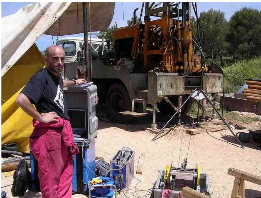
Fotografía 4.3. Detalle del registro de conductividad eléctrica y temperatura realizado durante la testificación geofísica del sondeo de investigación hidrogeológica “Martillo”.
