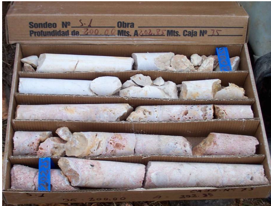
Fotografía 3.3. Detalle de la alteración de las dolomías de la base de la formación Camarena, en el testigo del sondeo Cañada Honda (1541/4/0060)
