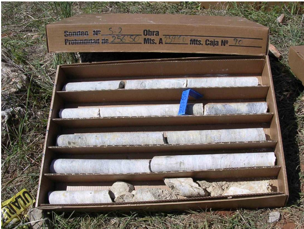
Fotografías 3.1 y 3.2. Detalle de las arcillas y yesos triásicos de los testigos de sondeo correspondientes a las perforaciones Cañada Honda, 1541/4/0060, (arriba) y Martillo, 1541/4/0062 (abajo).
