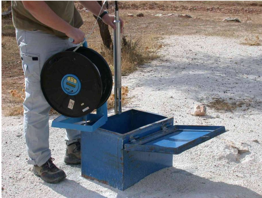
Fotografía 4.2. Detalle de la sonda de conductividad eléctrica y temperatura SEBA (de 300 m de longitud) utilizada para realizar los registros.
