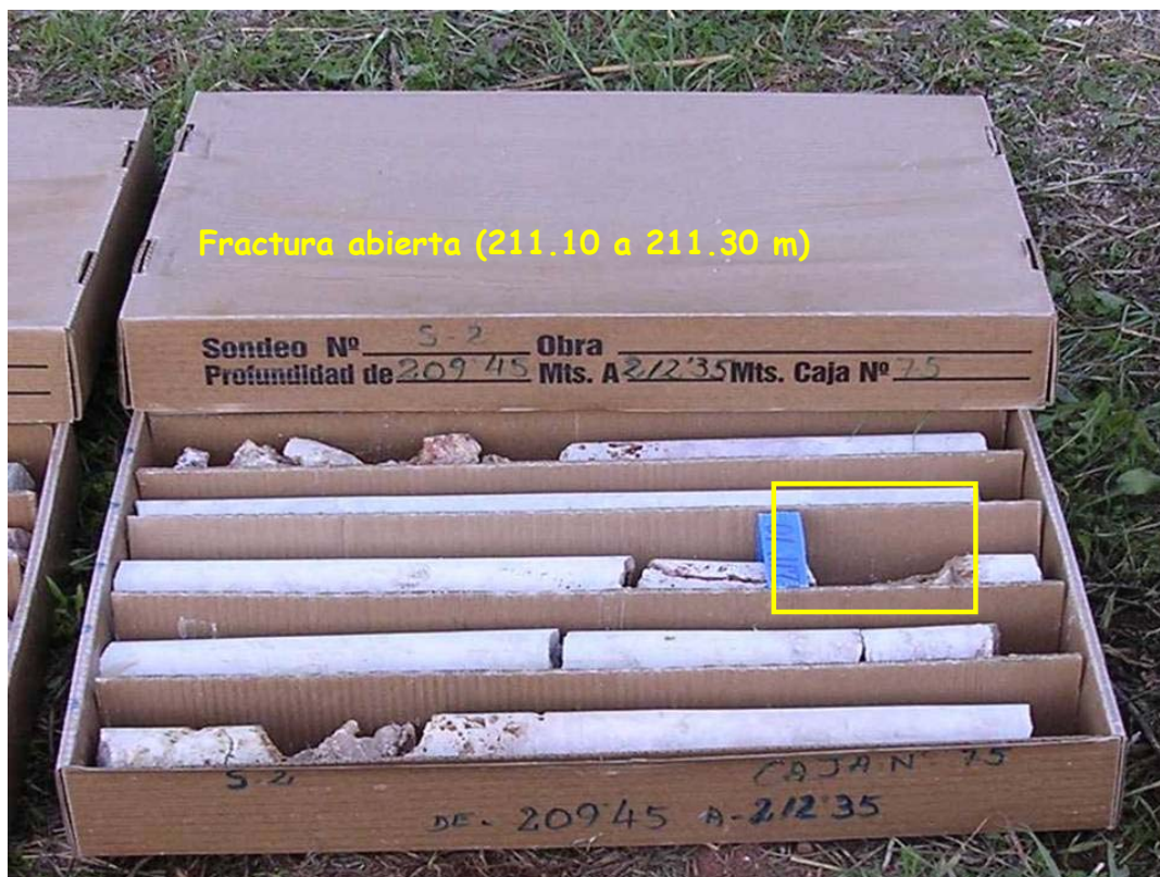
Fotografía 6.2. Testigo del sondeo Cañada Honda (209,45 a 212,35 m), en el que se identifican importantes discontinuidades abiertas.
