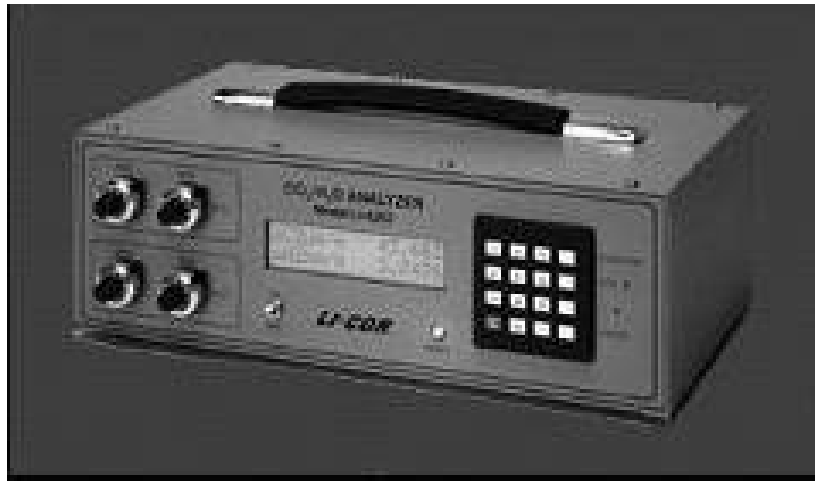
Figura 3.25: Fotografía de un IRGA modelo Li-6262 closed path
