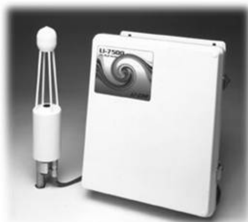
Figura 3.26: Fotografía de un IRGA modelo Li-7500 open path
