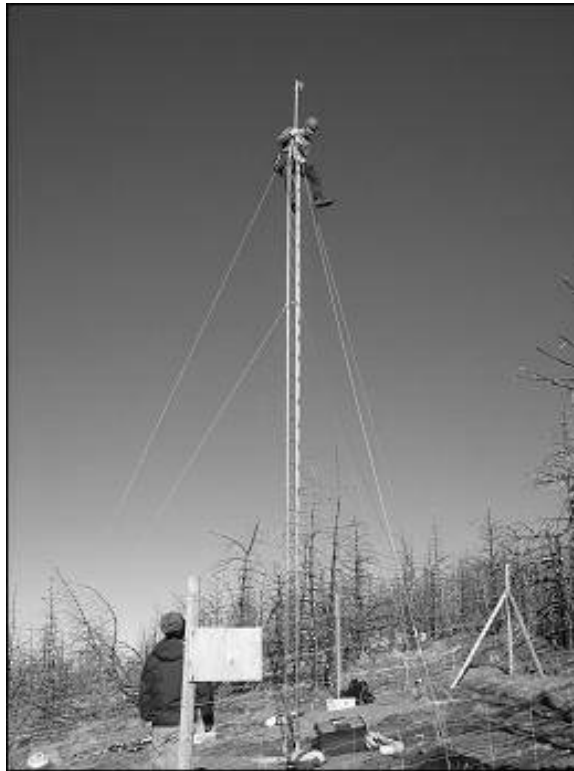
Figura 2.8: Torre de flujos turbulentos de la zona experimental de Lanjaron.
