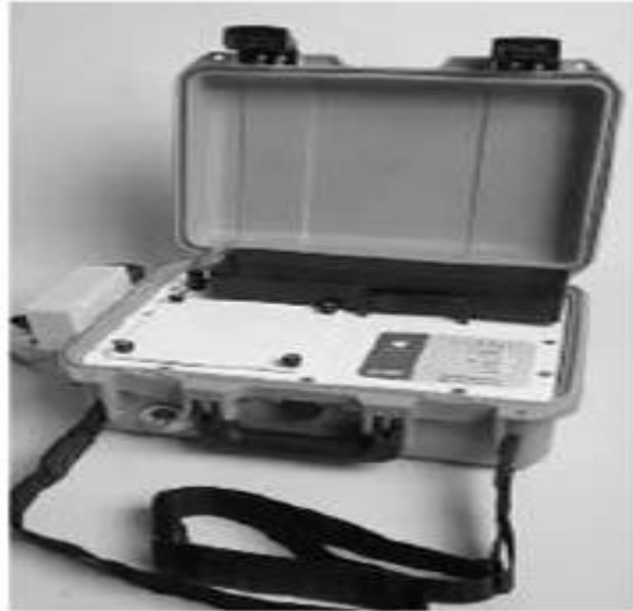
Figura 4.1: Unidad principal del sistema LI-8100.
