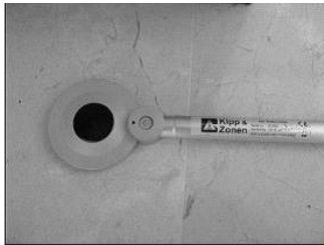
Figura 3.28: Fotografía de un radiómetro neta modelo NR Lite.
