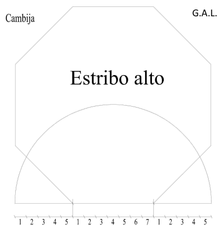
Fig. 3 cálculo del lado del ochavo para el estribo alto.
