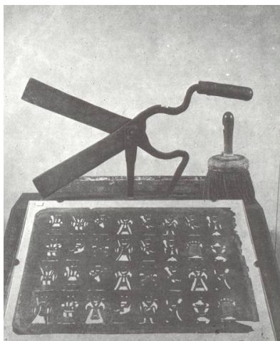
Fig. 46 Patrones para colorear naipes llamados trepas, con tijera de cortar y brocha. Museo Fournier de Naipes de Vitoria.
