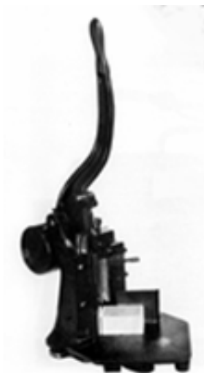
Fig. 72 Máquina redondear naipes en vertical, siglo XX.
