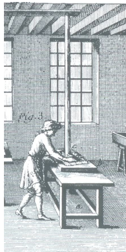
Fig. 44 Bruñidor suspendido del techo
