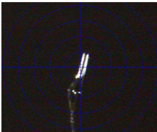
Figura 2.9. Cristal del mutante N114A de Abl-SH3 montado en un lazo para su difracción en el equipo mostrado en la Figura 2.8. El cristal se centra en el haz de rayos X con el programa Proteum2Server instalado en dicho equipo.
