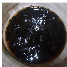
Figura 8.43. Fango formado con SAL-8.2+A/30.L a pH 12.
