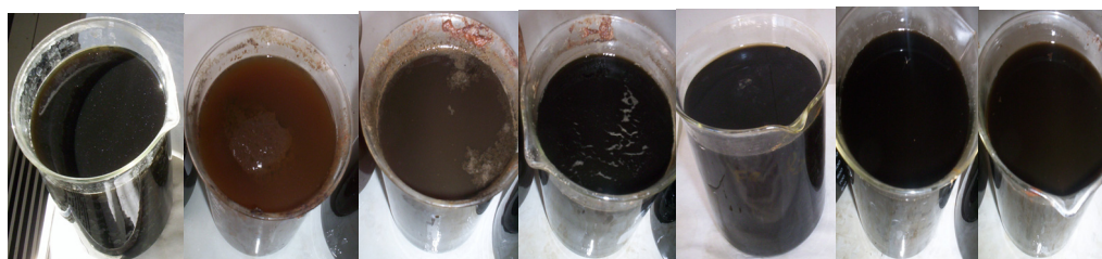
Figura 8.38. Aspecto del lixiviado tras coagulación-floculación con Cloruro férrico+A/20.L a distintos valores de pH (lixiviado bruto sin adición de reactivos, pH 2, 4, 6, 8 (sin ajuste), 10 y 12, respectivamente).
