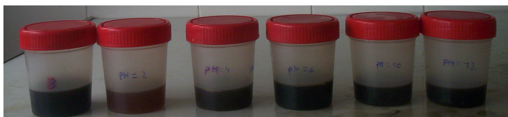
Figura 8.39. Aspecto del sobrenadante a distintos valores de pH tras coagulación-floculación con Cloruro férrico+A/20.L.
