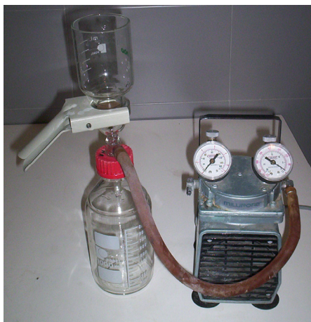
Figura 7.12. Equipo de filtración.
