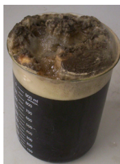
Figura 8.36. Aspecto de las espumas formadas al ajustar el pH con ácido sulfúrico 8 N.
