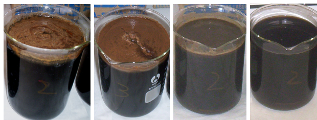
Figura 8.21. Comparativa del aspecto de las espumas formadas con (de izquierda a derecha) Cloruro férrico, Ferriclar, SAL-8.2 y PAX-18.
