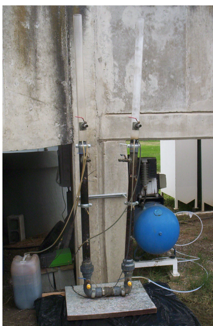
Figura 8.47. Planta de lechos inundados a escala de laboratorio empleada en Granada.
