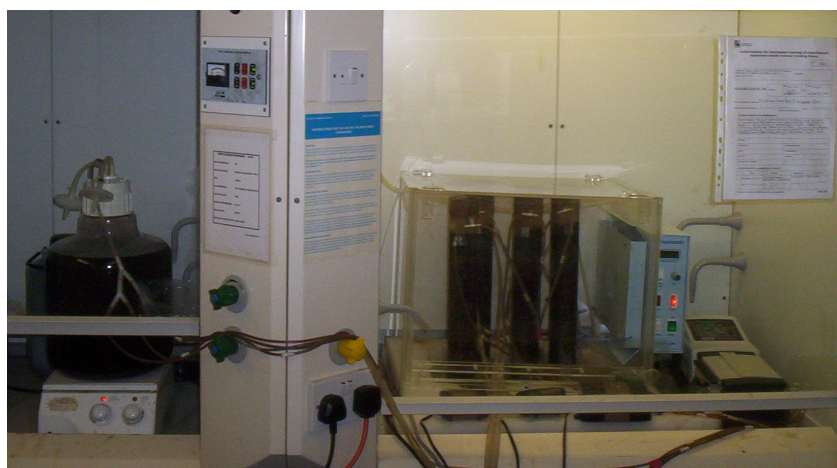
Figura 8.98. Planta de lechos inundados a escala de laboratorio empleada en Bristol.
