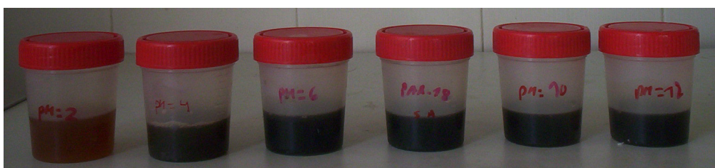
Figura 8.45. Aspecto del sobrenadante a distintos valores de pH tras coagulación-floculación con PAX-18+A/30.L.
