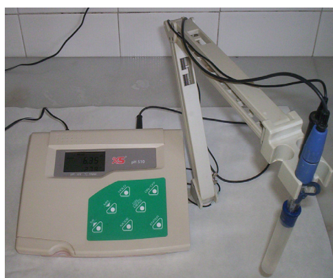
Figura 7.14. pHmetros: (A) pHmetro de sobremesa empleado en Granada, (B) pHmetro portátil empleado en Bristol.
