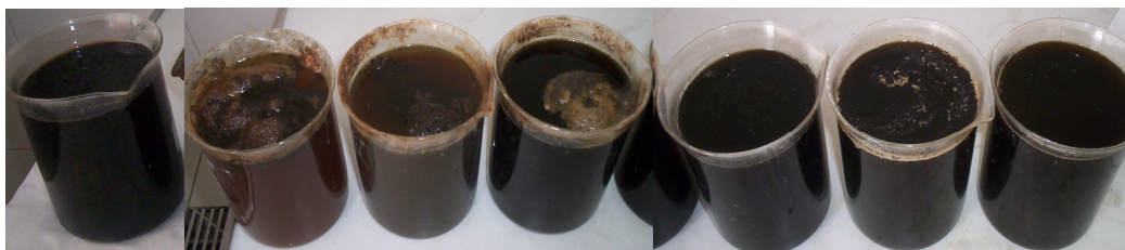
Figura 8.44. Aspecto del lixiviado tras coagulación-floculación con PAX-18+A/30.L a distintos valores de pH (lixiviado bruto sin adición de reactivos, pH 2, 4, 6, 8 (sin ajuste), 10 y 12, respectivamente).
