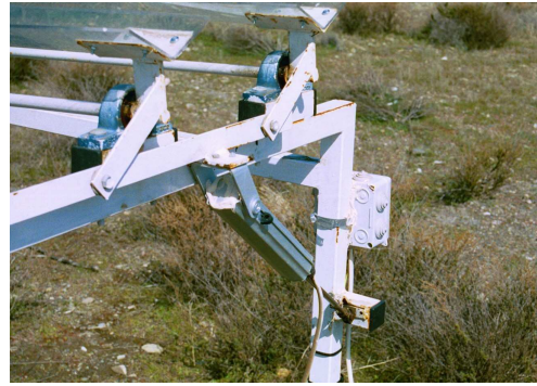
Foto 2.- Detalles de instalación del sistema automático que controla el movimiento de las bandas de policarbonato. a) Controlador del sistema. b) Detalle pantalla LCD. c) Motor que controla el movimiento en cada sistema de exclusión de lluvia.
