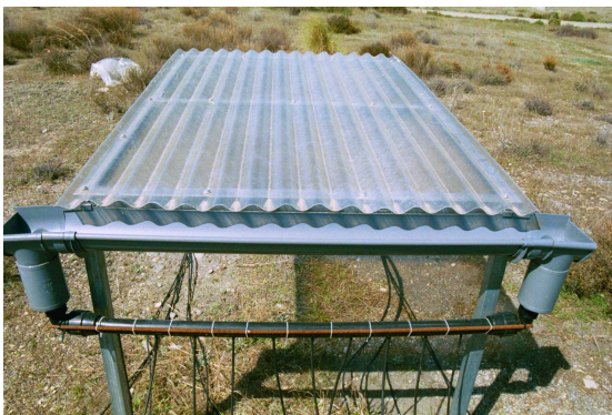
Foto 3.- Techos y microtubos usados para el refuerzo de lluvia durante el invierno en las parcelas sometidas a una alteración de la distribución estacional de la precipitación.
