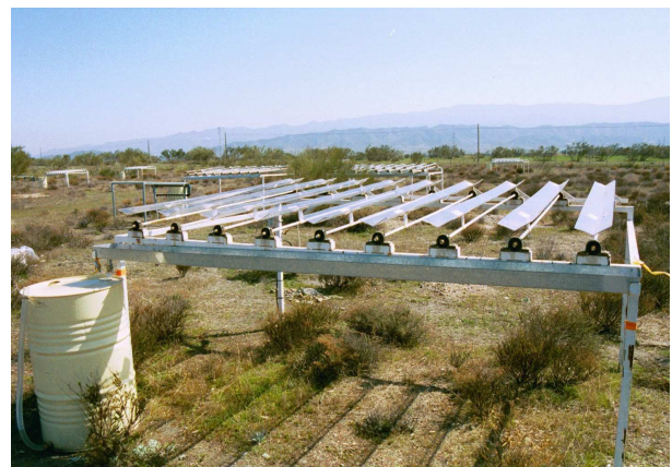
Foto 1.- Fotografía de los sistemas de exclusión de lluvia instalados en las proximidades de Tabernas, en terrenos de la Plataforma Solar de Almería. Las láminas están en posición de interceptar la lluvia.
