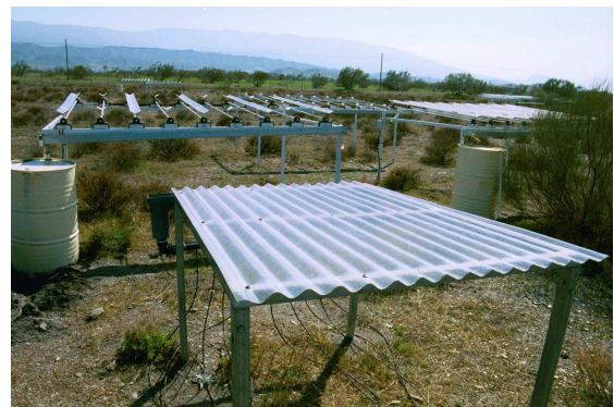
Foto 3.- Techos y microtubos usados para el refuerzo de lluvia durante el invierno en las parcelas sometidas a una alteración de la distribución estacional de la precipitación.
