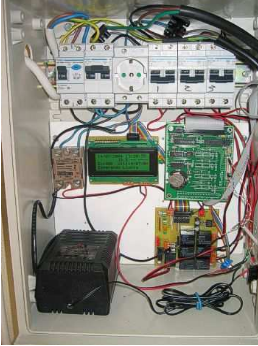
Foto 2.- Detalles de instalación del sistema automático que controla el movimiento de las bandas de policarbonato. a) Controlador del sistema. b) Detalle pantalla LCD. c) Motor que controla el movimiento en cada sistema de exclusión de lluvia.
