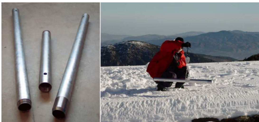
Figura C.1: Conjunto de tubos tomamuestras de nieve. Operación de pesaje en campo.
