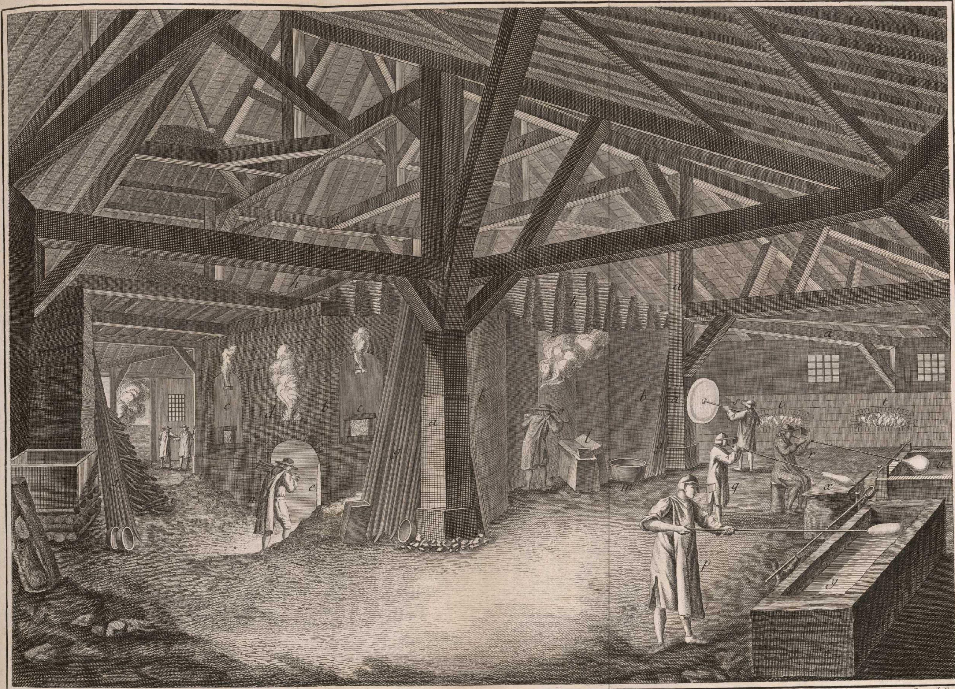
Verrerie en bois, Grande Verrerie en Plats. Intérieur d'une Halle et différentes Opérations de la Verrerie à Vitres.
