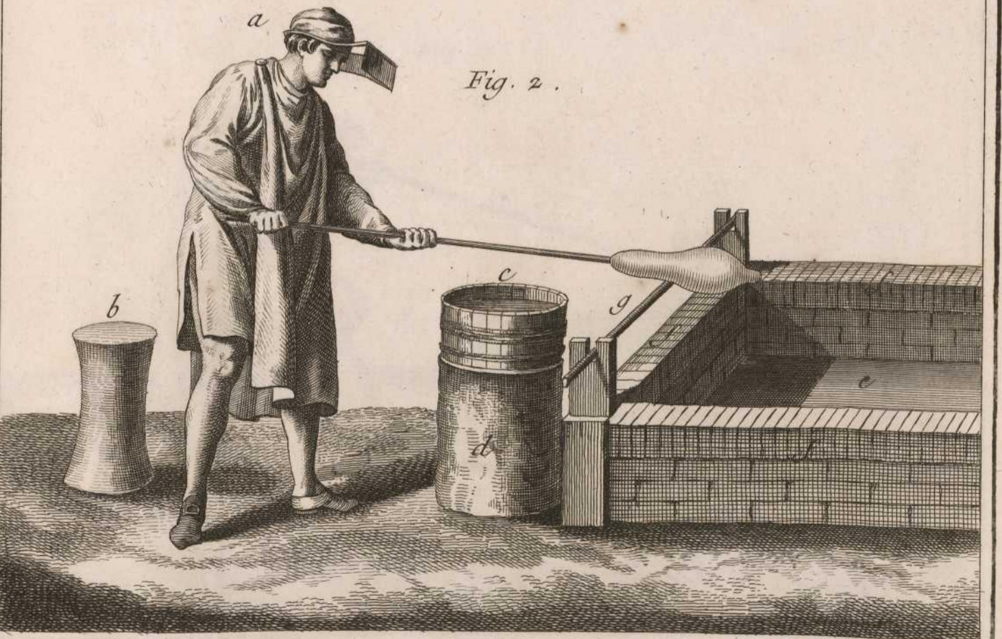
Verrerie en bois, l'opération de rouler la 3 e Chaude et former le col de la Bosse.
