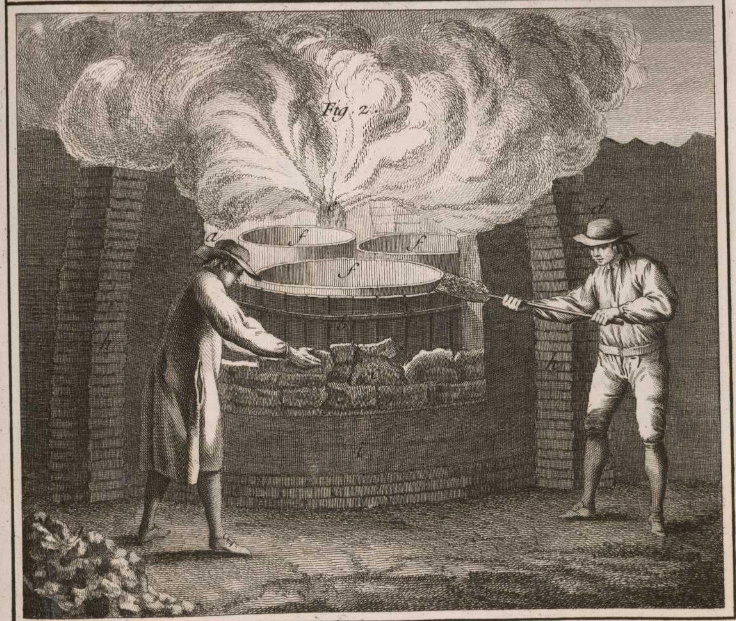
Radel Del. Verrerie en bois , l'Opération de transporter les Pots de la Carcasse au Four, et l'Opération de fermer la grande ouverture du Four avec de la terre glaise contenue par le bonhomme. Benard Fecit.
