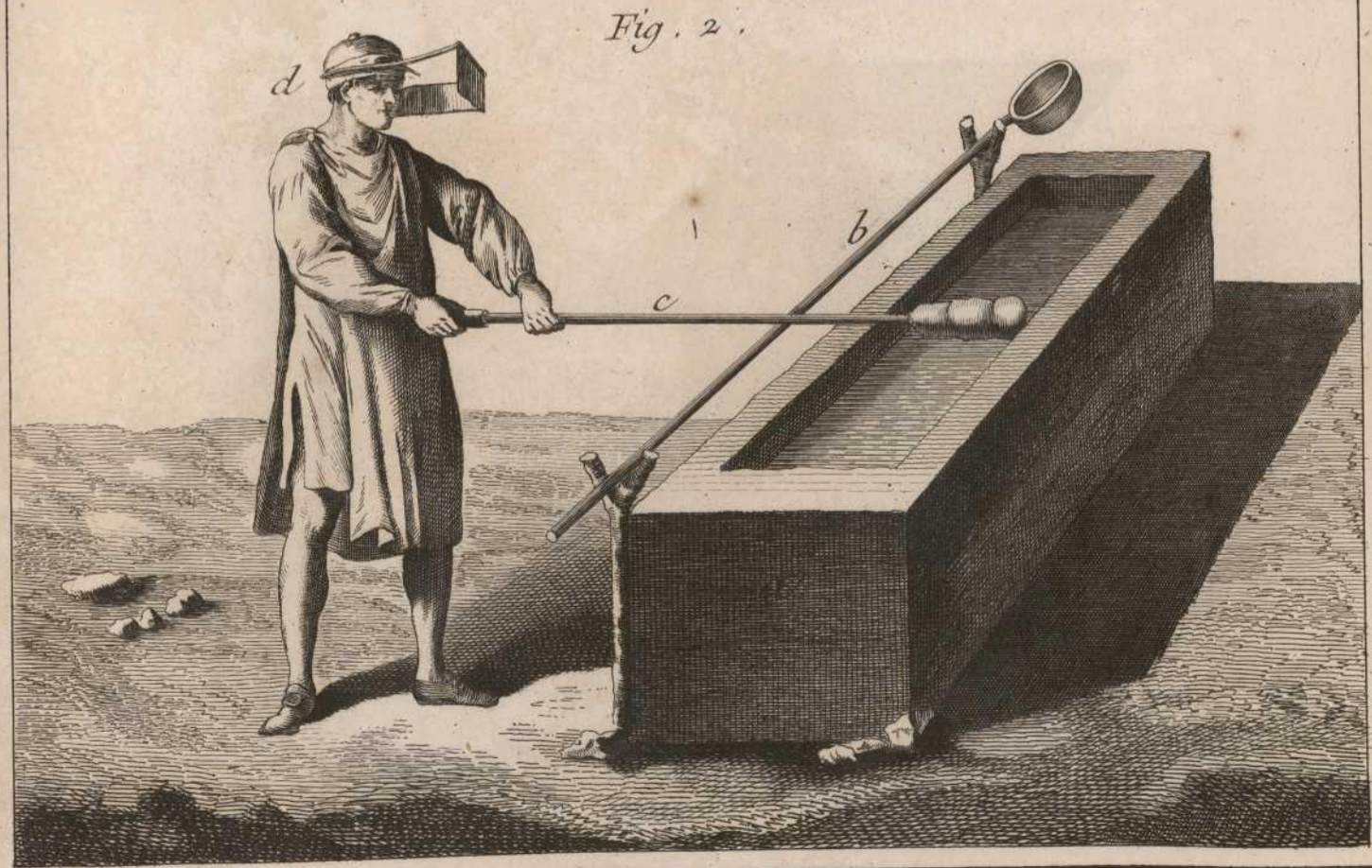
Verrerie en bois, l'Opération de faire le cueillage avec la Felle et de l'alonger à l'auge.
