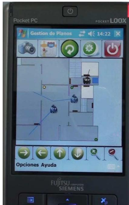
Figura 4.13: Ejemplo de localización de usuarios en tiempo real en un dispositivo móvil
