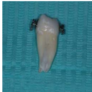
Fig. 1: Preparación de los especímenes. Pulido, acondicionamiento y cementación de los brackets.
