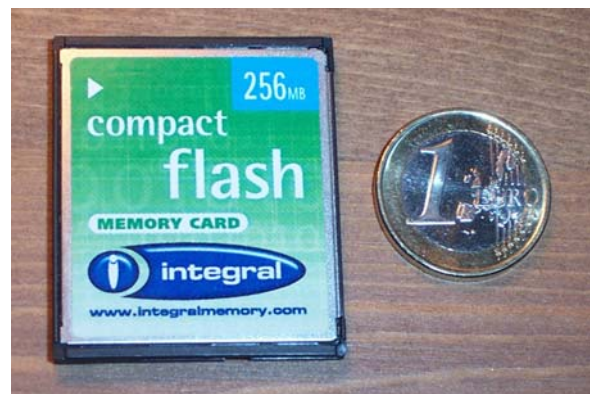
Figura 7.1. Imagen de una tarjeta de memoria Compact Flash de 256MB. Existen dos tipos de tarjetas, denominados Tipo I y Tipo II, que se diferencian en el grosor, de 3.3 y 5mm, respectivamente.
