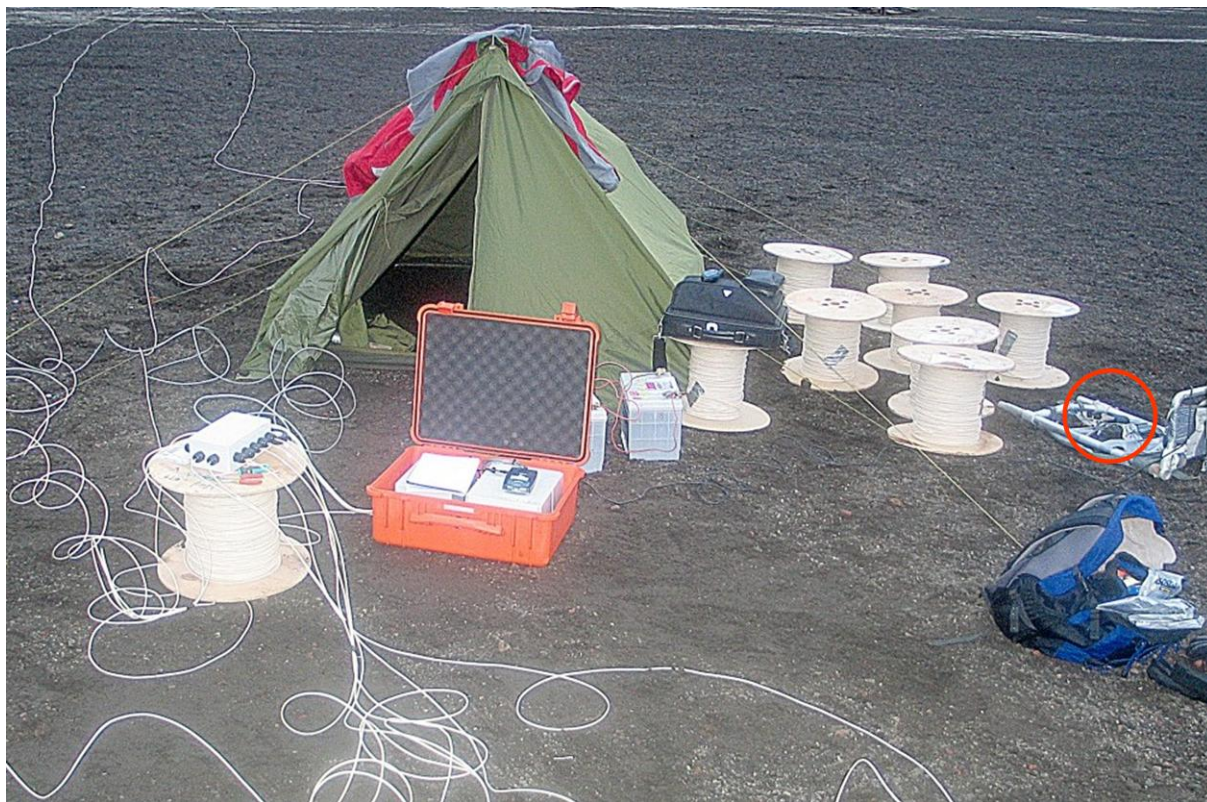
Figura 5.18. Fotografía de una de las nuevas antenas portátiles del IAG durante la campaña TOMODEC, en la isla Decepción (Antártida). En el centro se puede ver el módulo central abierto, en el que se distingue el disco externo USB y las dos cajas de la electrónica. El receptor GPS queda a la derecha, dentro del círculo rojo. A la izquierda del módulo central puede verse la caja de conexiones, de la que parten los distintos cables hacia los sensores. También se observan en la imagen las baterías, las bobinas de cable utilizadas y la tienda de campaña, que se usa como protección del personal durante las labores de mantenimiento y de los equipos durante su operación.
