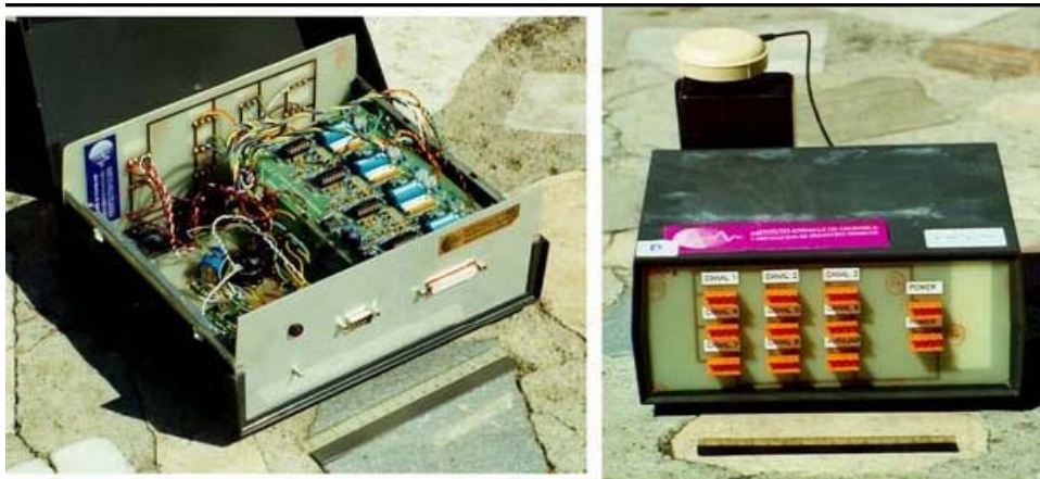
Figura 5.3. Diagrama de bloques de los módulos de dieciséis bits (a). Los ocho sensores verticales pueden sustituirse por cualquier combinación de sensores de una o tres componentes, hasta ocupar el máximo de ocho canales que es capaz de gestionar cada módulo. En b) se muestran dos imágenes de uno de los módulos. A la derecha, el módulo cerrado, en el que se aprecian las fichas de conexión de los ocho canales de adquisición de datos y de la batería (más dos fichas de reserva). Detrás del módulo puede verse la antena GPS. No se muestra el PC portátil que controla el sistema. A la izquierda puede verse el módulo abierto. En primer término aparecen los conectores de cable serie, paralelo y de la antena GPS. Además se distinguen, dentro de la caja, la tarjeta de interfaz GPS (a la izquierda) y una de las placas de acondicionamiento de señal analógica. Debajo de ésta quedan la otra tarjeta de acondicionamiento y la tarjeta de conversión A/D.
