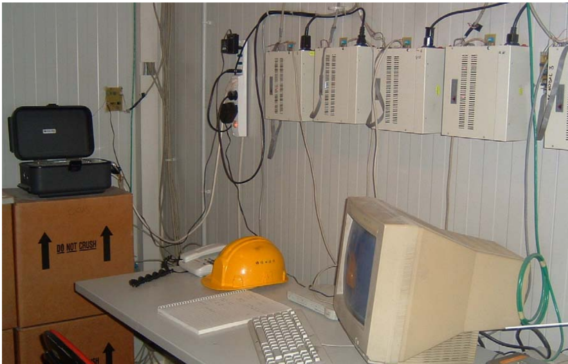
Figura 3.34. Fotografía del interior de la sala de control. A la izquierda de la imagen puede verse el oscilador patrón. En primer plano, el teclado y monitor del servidor, y sobre él los PCs nodales fijados a la pared. Detrás del monitor puede verse el concentrador para la red ethernet .
