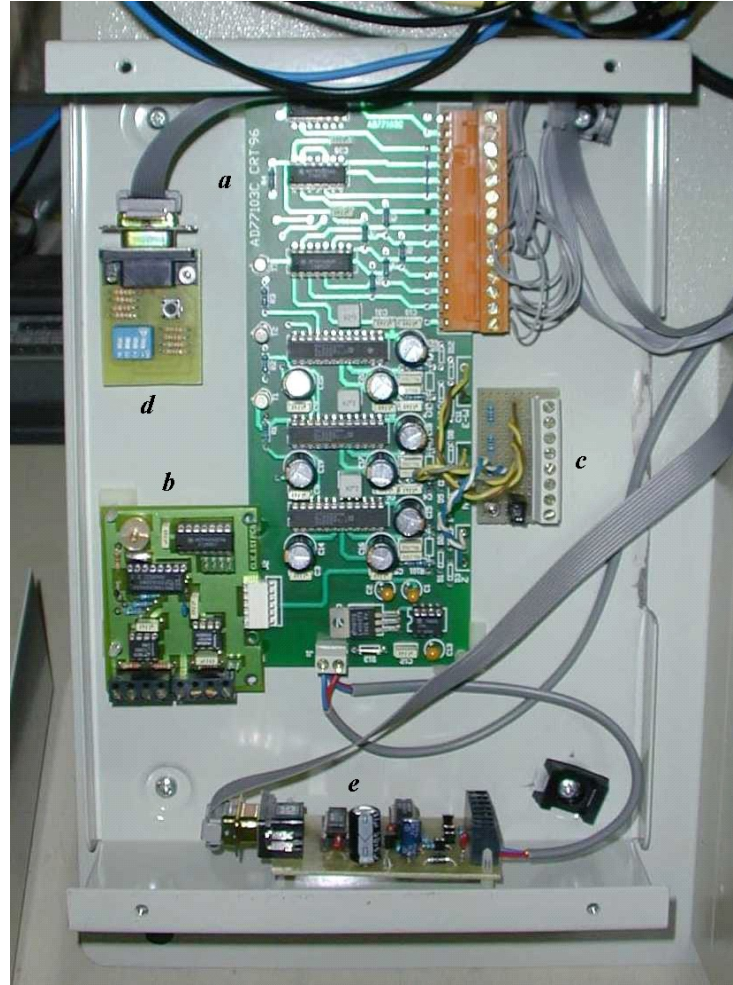
Figura 3.37. Imagen del interior de la caja con la electrónica de adquisición. Puede verse la placa de conversores analógico/digital (a), conectada al puerto paralelo del PC industrial mediante un conector de tornillos. A ella se conectan la placa de generación de las señales de reloj (b) y una pequeña placa para la adaptación de la salida de los geófonos (c). También pueden verse las placas de código de estación (d) y la de conversión de niveles RS-232/RS-485 (e), conectadas a los dos puertos serie del PC a través de sendos cables planos.
