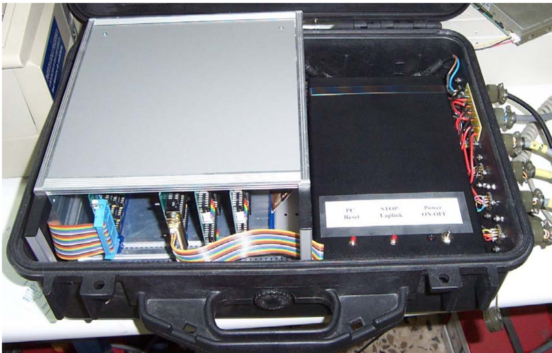
Figura 4.26. Fotografía del módulo central. A la izquierda se muestra el contenedor del back-plane para la tarjeta SerPar y las placas del módulo de memoria. A la derecha, la caja que contiene el PC, el disco duro y la fuente de alimentación para ambos. Pueden verse el cable plano que conecta la tarjeta SerPar con las distintas líneas serie a través de un conector IDC de 34 vías, así como el que conecta la tarjeta de control del módulo de memoria con el puerto paralelo del PC industrial, al que se accede a través de un conector D25 situado en la parte posterior de la caja del PC (figura 4.27). A la derecha de la fotografía se ve dicha caja, de color negro, con los pulsadores de reset del PC y salida del programa y el interruptor y LED de alimentación. En el lateral derecho, por la parte externa de la maleta, aparecen los cables de transmisión serie de datos, el cable de comunicación con el módulo de reloj y el cable de alimentación, conectados a los correspondientes conectores militares.
