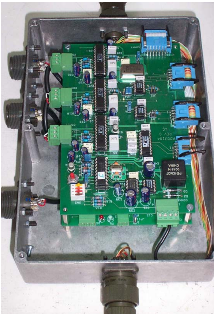
Figura 4.30. Fotografía de un módulo de adquisición, con la placa de conversión A/D en primer término y la tarjeta PLL debajo. En el exterior de la caja pueden verse los tres conectores para los sensores, en el lateral izquierdo, y los dos conectores para la conexión del módulo a la línea serie.
