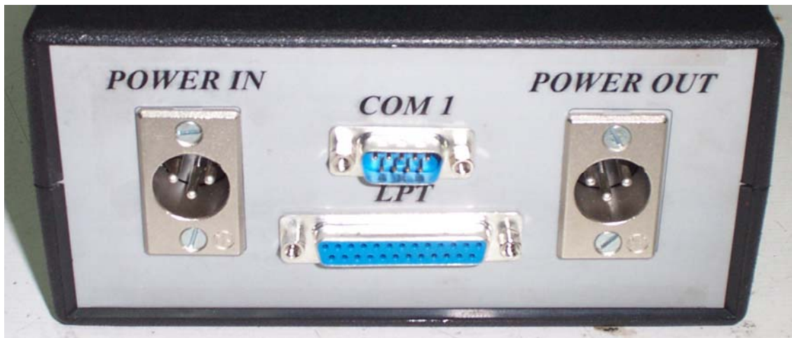
Figura 4.27. Fotografía del panel posterior de la caja del PC industrial, con los conectores D9 y D25 para acceder al puerto serie COM1 y al puerto paralelo del PC, respectivamente. La alimentación del PC y disco duro se toma de la batería externa a través del conector marcado como 'POWER IN'. El conector 'POWER OUT' se utiliza para llevar la tensión de la batería hasta la tarjeta SerPar. La fuente conmutada de dicha tarjeta toma esta tensión como entrada y ofrece la tensión regulada de salida (+5V) a todas las tarjetas del módulo de memoria a través del back-plane.
