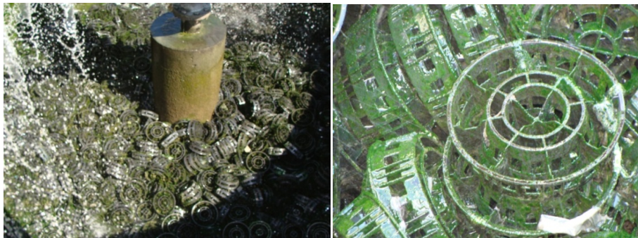
Figura 23. Relleno plástico de la instalación.
