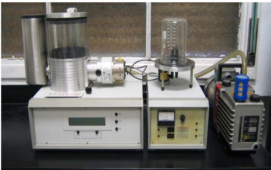
Figura 15. Criodesecador de alto vacio Emitech K775 (Emitech, Watford, UK) utilizado en esta Tesis Doctoral.
