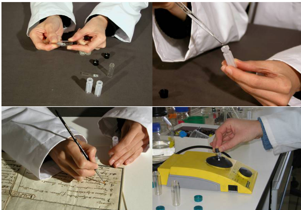
Figura 5.5: Toma y tratamiento de muestra de colorantes en documentos gráficos
