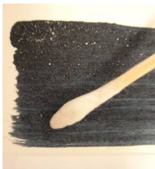
Figura 5.2: Toma de muestra con la ayuda de un hisopo
