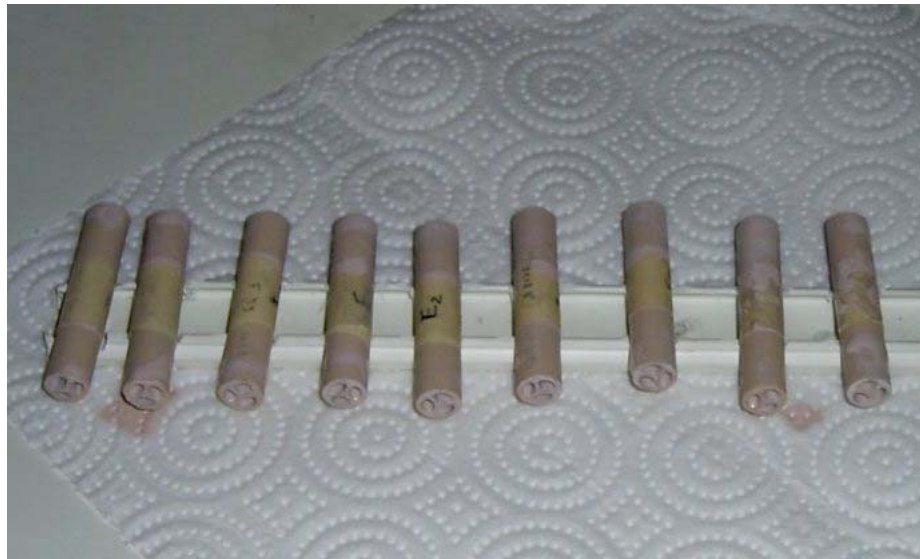
Figura 3.5. Fotografía de los trozos de membrana para el análisis LLDP.
