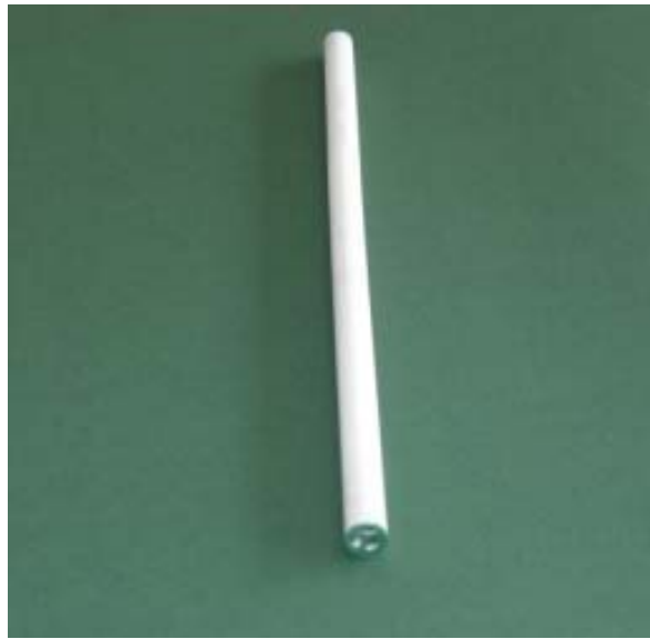
Figura 3.1. Imagen de la membrana cerámica de 25 cm.
