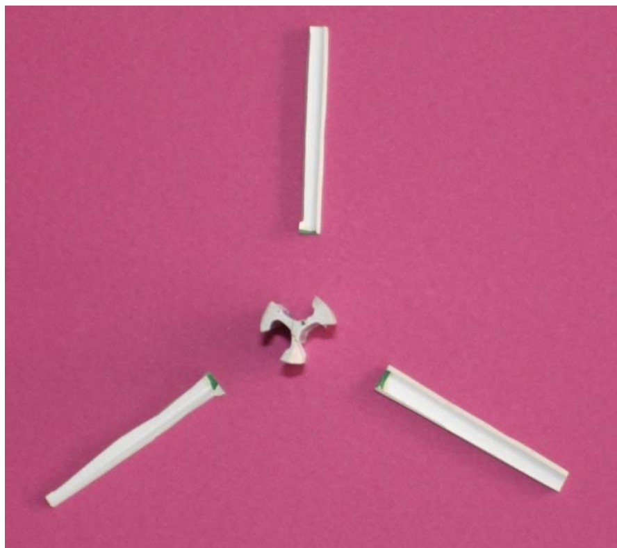
Figura 3.6. Cortes de las paredes de la membrana destinados a microscopía.
