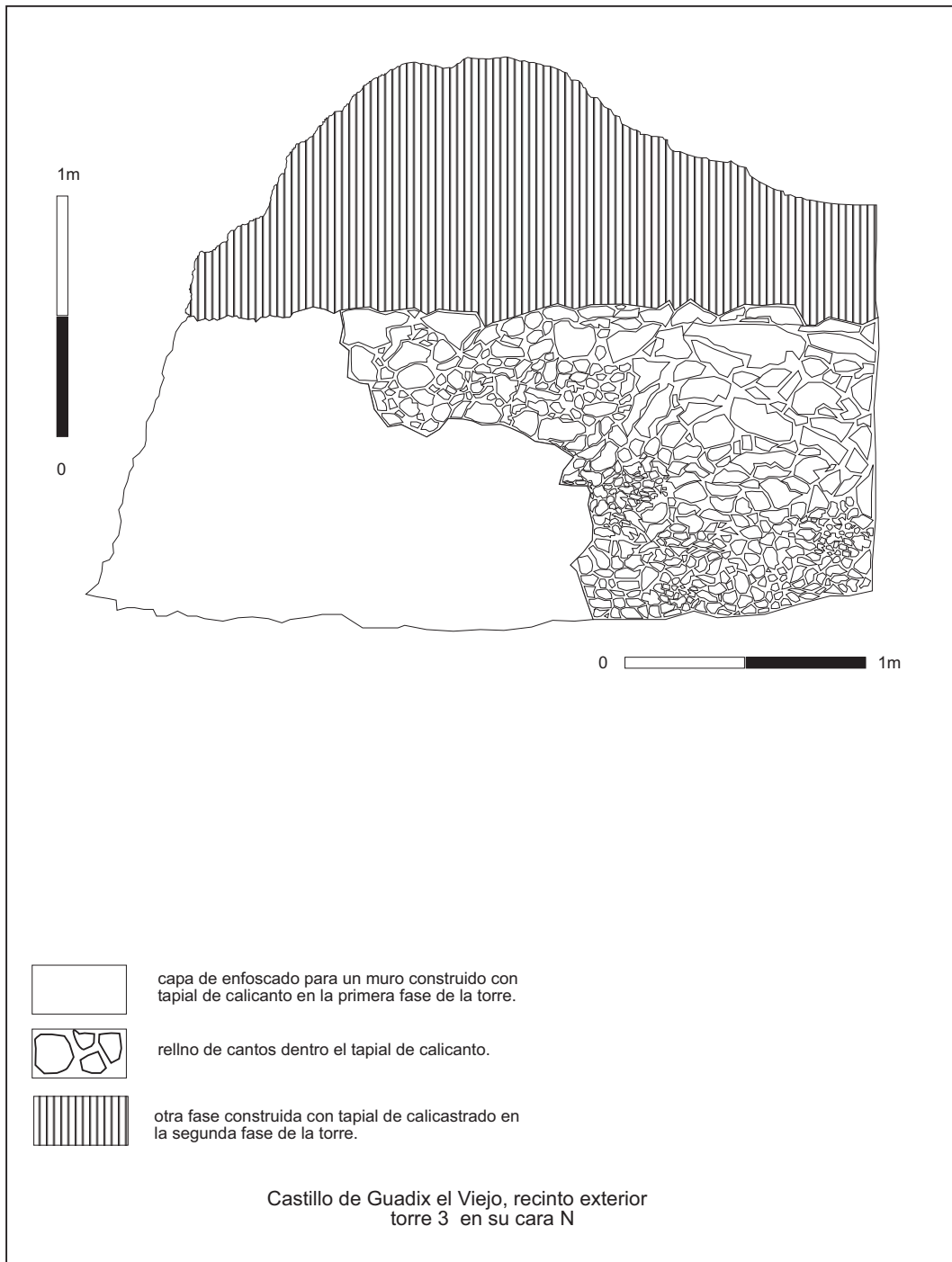
Figura 8. Castillo de Guadix el Viejo, torre 3 del recinto exterior en su cara N. La técnica constructiva, tapial de tierra.
