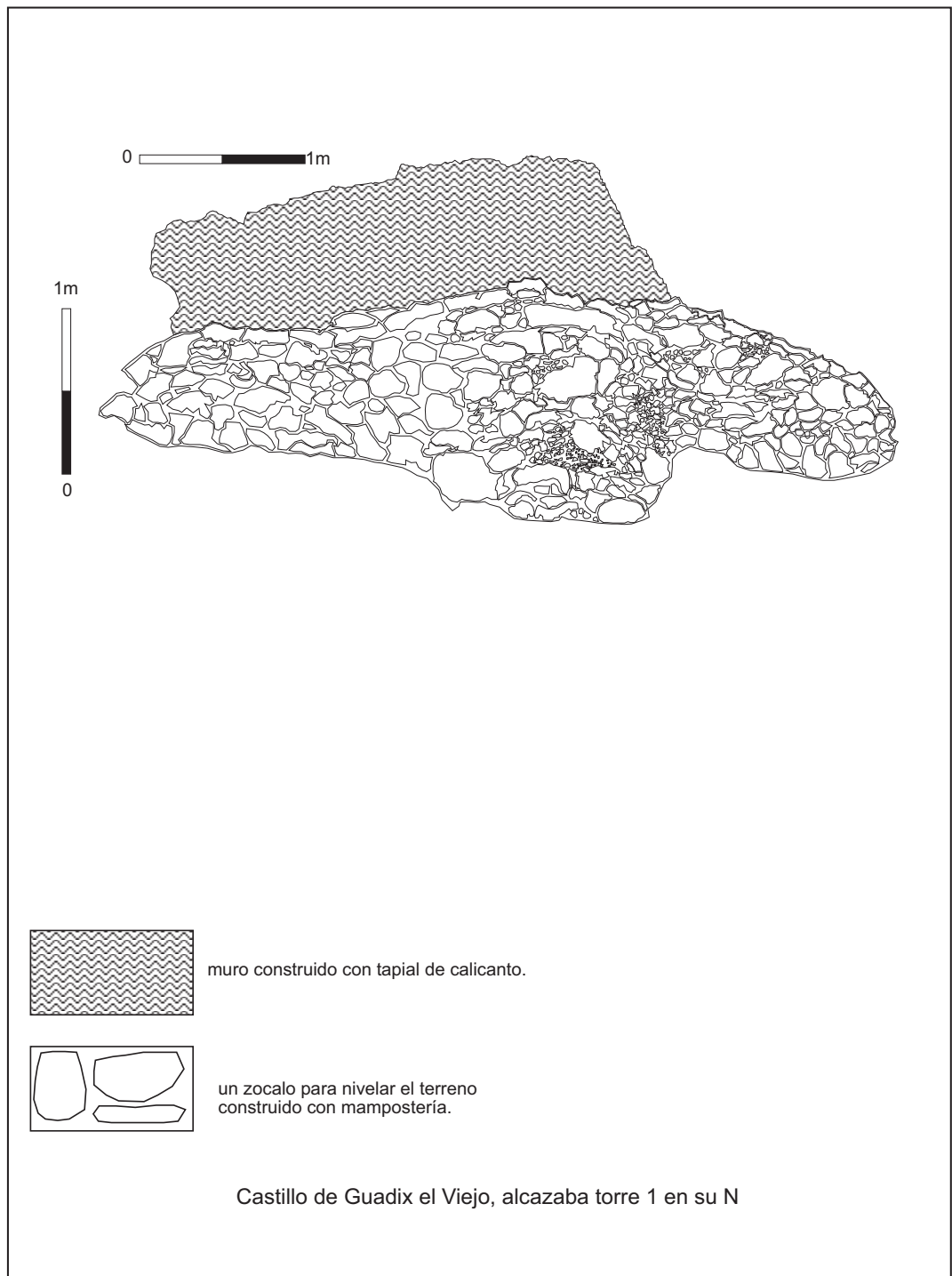
Figura 16. Castillo de Guadix el Viejo, torre 1 de Alcazaba en su cara N. La técnica constructiva es: tapial de calicanto.
