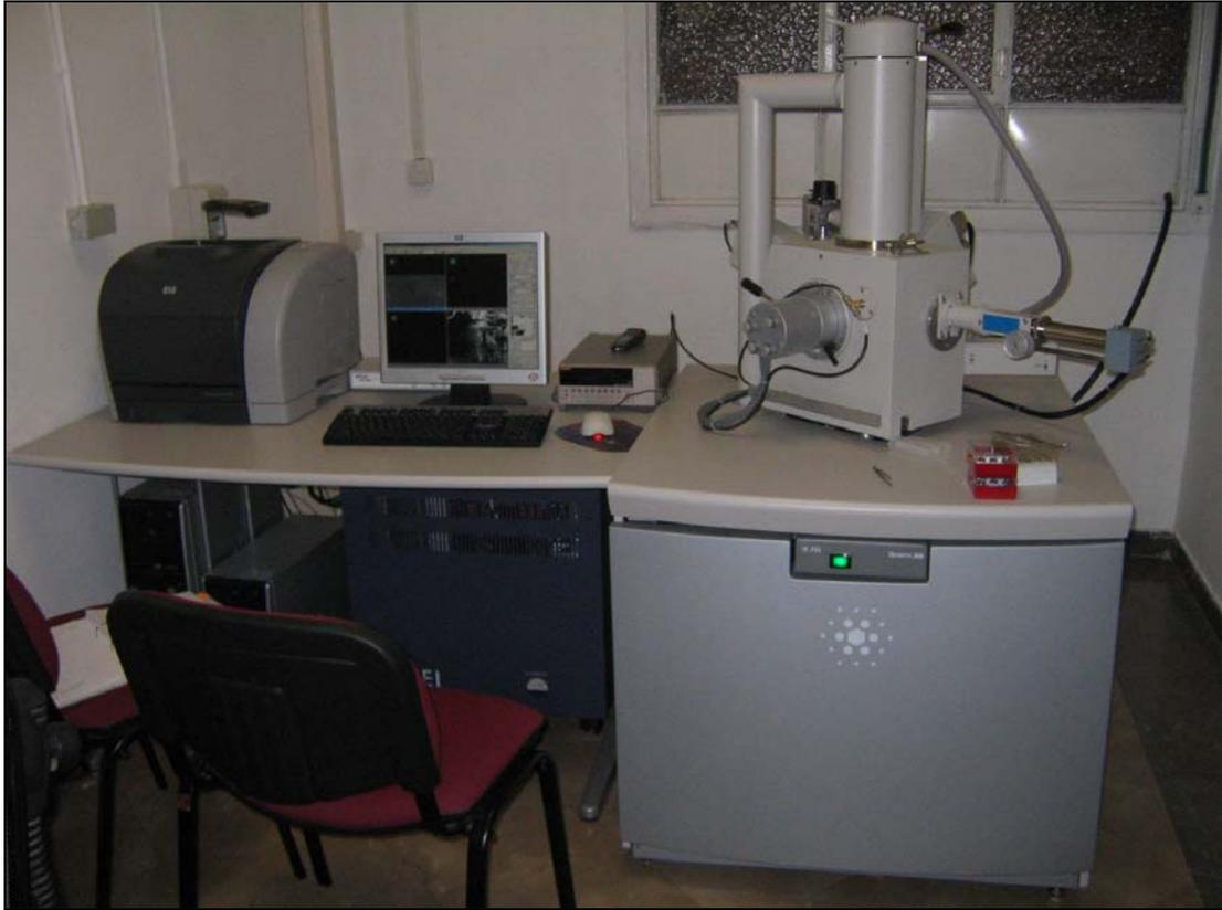
***Figura 27. Microscopio electrónico de barrido FEI Quanta 200. Utilizado en esta Tesis Doctoral.***
