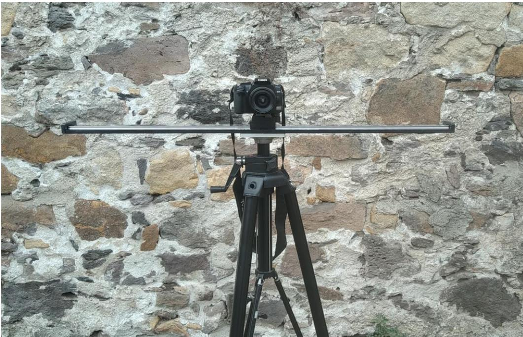
**Fig. 5 - Il sistema ZScan: treppiede, slitta graduata e fotocamera metrica.**
