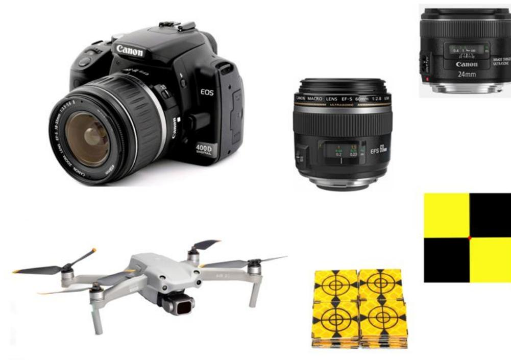
**Fig. 11 - Alcuni degli strumenti utilizzati nel rilievo Structure from Motion: fotocamera digitale reflex, ottiche fisse da 24mm e 60mm, drone, target di riferimento.**
