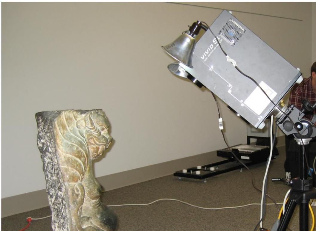
**Fig. 23 - Rilievo di una scultura con 3D scanner a luce Strutturata Konica Minolta Vivid 900i (fonte: xts.uchicago.edu).**
