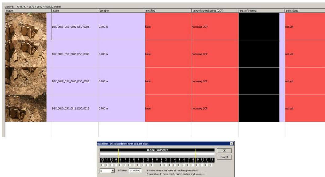
**Fig. 8 - ZScan: interfaccia del software dopo l'inserimento delle triplette e scelta della baseline.**
