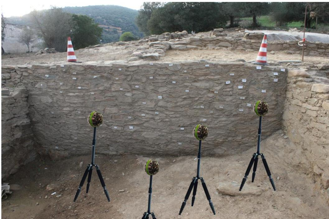
**Fig. 72 - Fusti'e Carca (Tertenia): simulazione della quattro postazioni utilizzate per il rilievo dell'ambiente I con Panono 360.**
