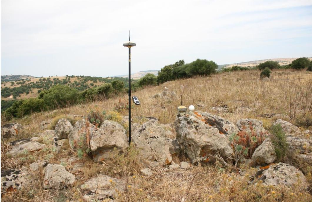
**Fig. 81 - DGPS nelle fasi di rilievo di un circolo di pietre.**
