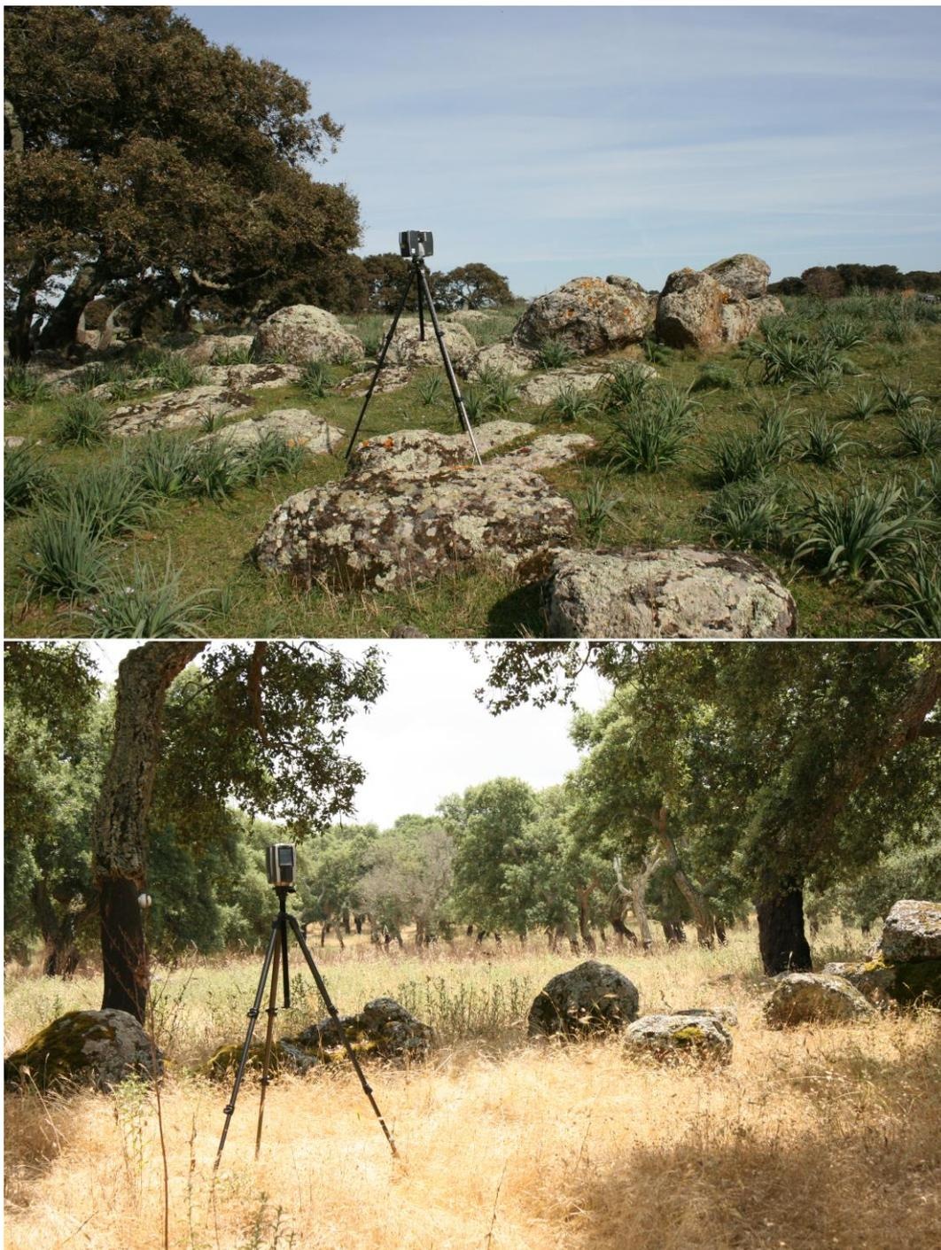
**Fig. 82 - 3D laser scanner: rilievo di un circolo di pietre.**
