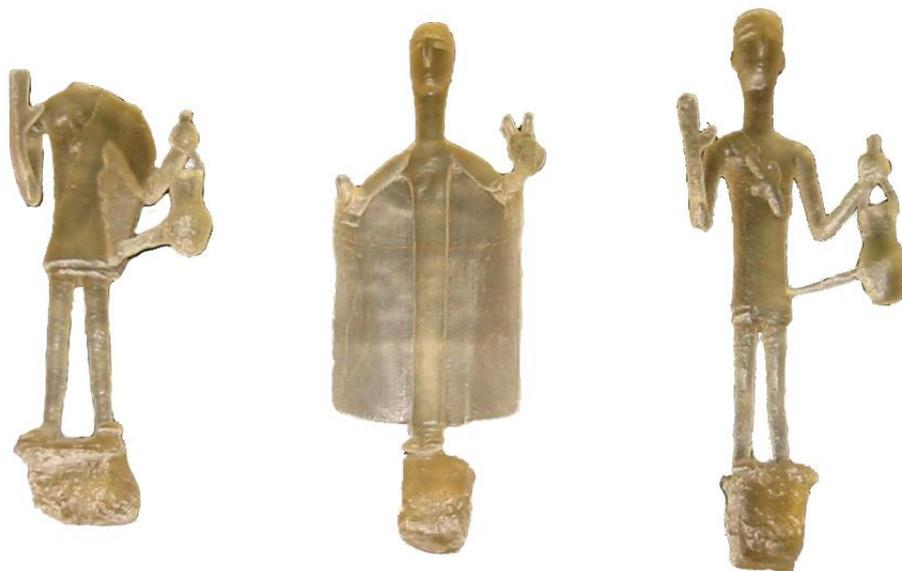
**Fig. 39 - Copie dei bronzi in resina al termine della procedura di stampa e di rimozione della resina di supporto.**
