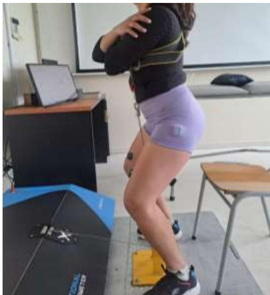
**Figura 2.** Medición de fuerza, potencia y trabajo durante la evaluación dinamométrica del iSTS-TS en una participante femenina.
