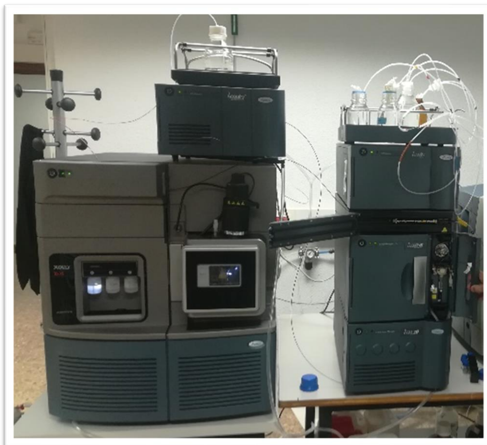
Imagen 1. Equipo UHPLC-MS/MS empleado en la determinación del BPA y sus análogos en los alimentos y las matrices biológicas
