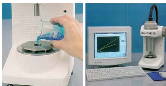
Figura 19: Reómetro Bohlin CSR-10 y detalle del sistema de medida para pequeñas muestras.
