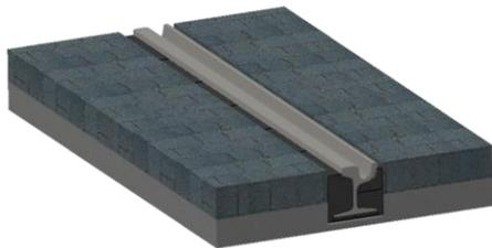
Solución convencional: aislamiento eléctrico y acústico mediante enchaquetado del carril
