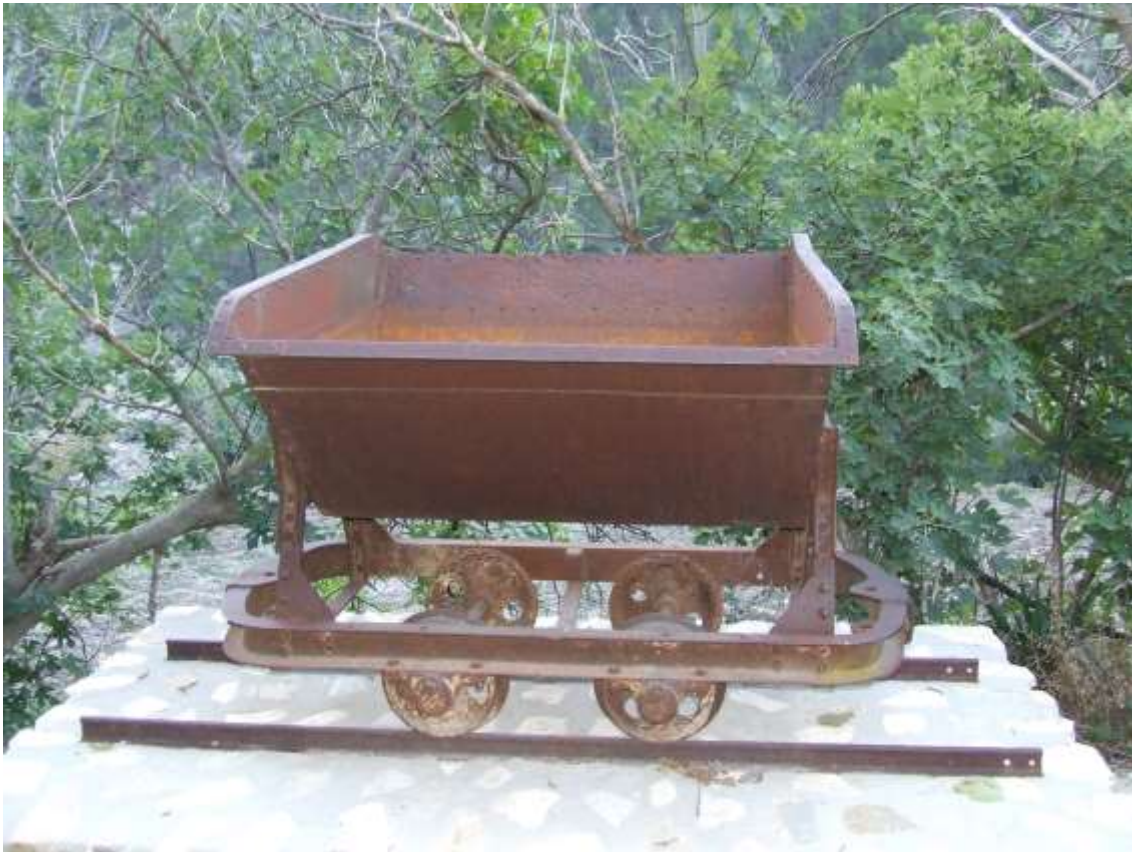
10. Vagoneta para extraer los escombros producidos en el interior de los túneles conforme se iban excavando. Fotografía de Francisco Martínez Sevilla
