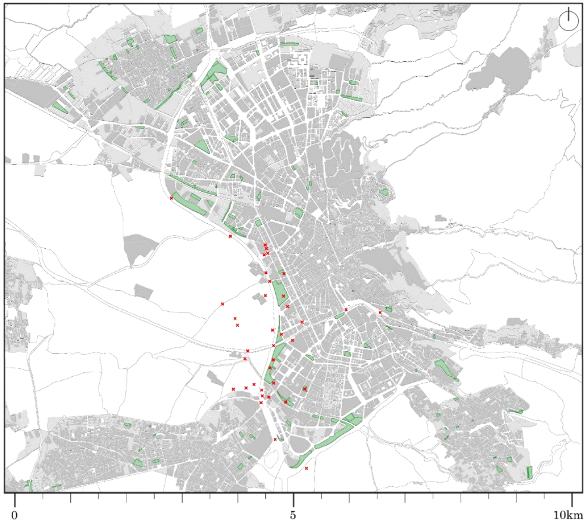
Figura 19. Puntos calientes de material particulado obtenidos a partir de la superposición de los mapas horizontales de \beta_{att} con el plano de la ciudad. Se marca con cruces aquellos puntos en los que aparecen valores de \beta_{att} mayores de 4 \cdot 10^{-6} \text{ m}^{-1} \text{ sr}^{-1} en un mínimo de tres ocasiones.
