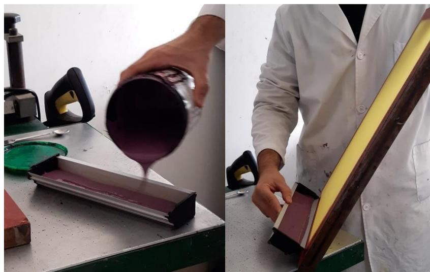
**Figura 2.7** Proceso de emulsión de la pantalla de serigrafía.
