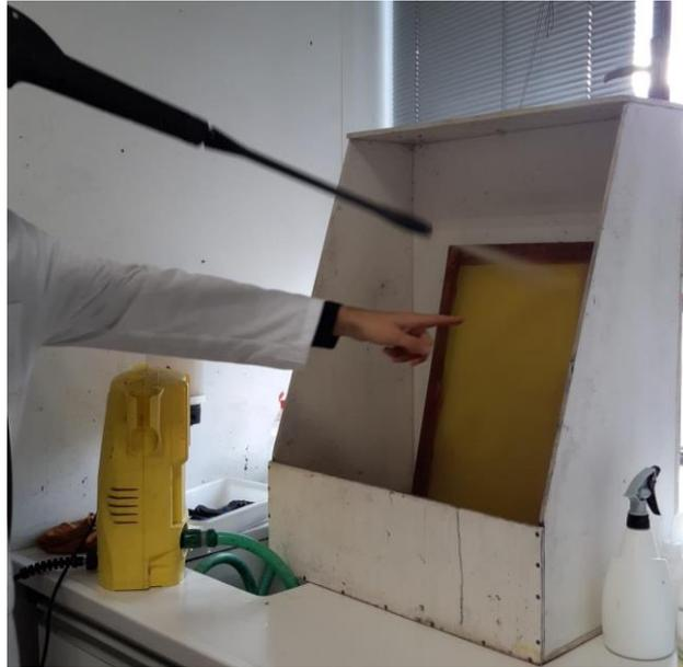
**Figura 2.9** *Proceso de eliminación de emulsión de la pantalla de serigrafía.*
