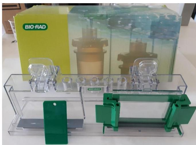
**Figura 2.20** Soporte de gelificación de la casa comercial Bio-Rad.
