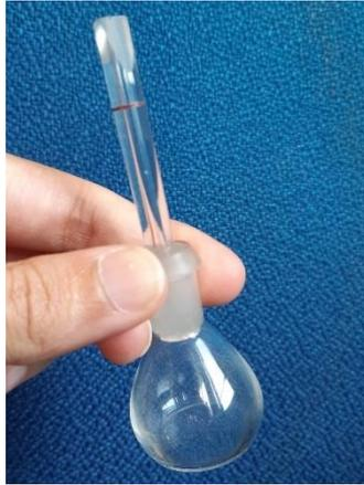
**Figura 2.30** Picnómetro de 5 mL de la casa comercial Probus.
