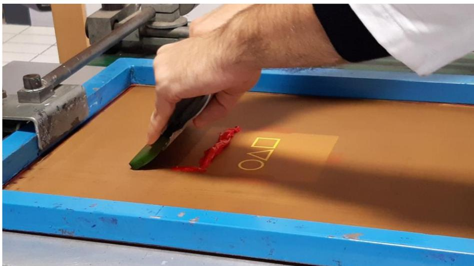
**Figura 2.6** Serigrafiado de un sustrato plano de papel con tinta de plastisol.
