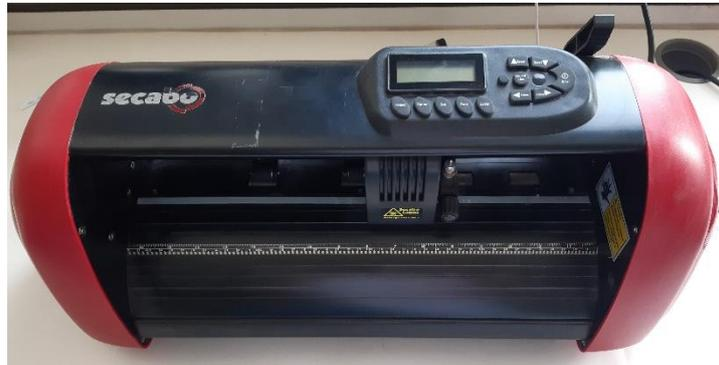
Figura 2.3 Plotter de corte X-Y de la casa comercial Secabo GmbH.
