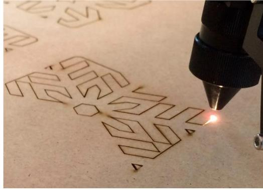
**Figura 1.12** Corte láser de una pieza de conglomerado.
