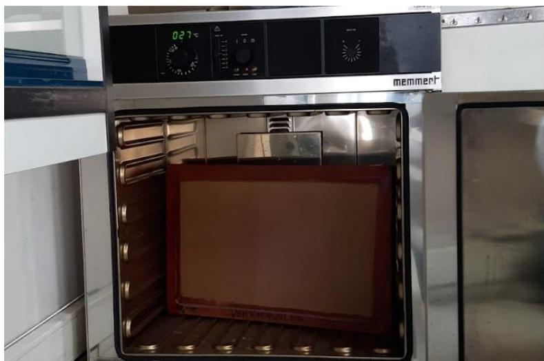
**Figura 2.8** Proceso de secado de la emulsión de serigrafía en horno.
