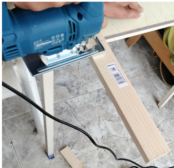
Fig. 58. Cortando los listones con la caladora.
