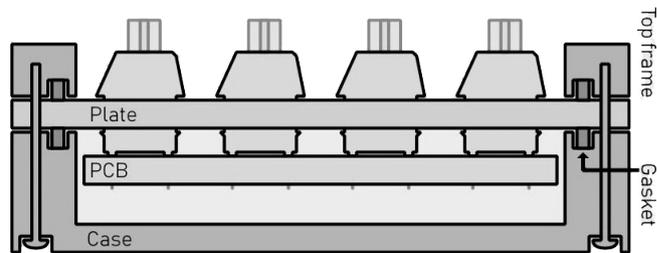
Figura 3.11: Montaje en empaquetado [24]
