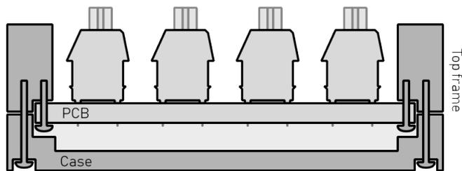
Figura 3.12: Montaje sin **plate** [24]
