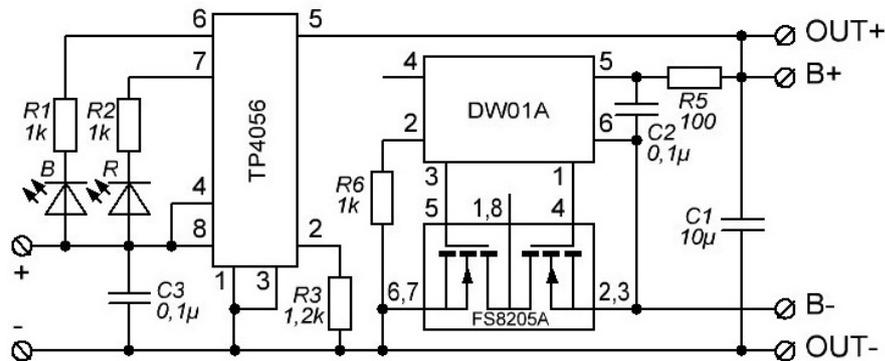
Figura 3.17: Esquemático del módulo TP4056 [28]
