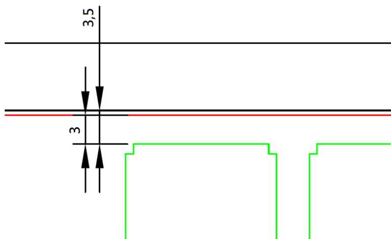
Figura 13.2: Imagen del plano acotado del espacio entre las **keycaps** y la madera.
