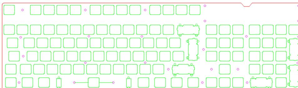
Figura 5.2: Imagen del plano de la [PCB](#) [9]
