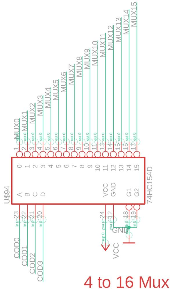
Figura 4.2: [Multiplexor](#) con todos los pines conectados a sus salidas/entradas [8]
