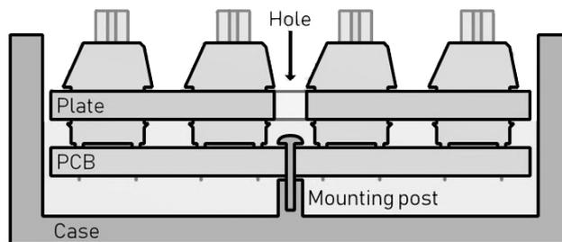
Figura 3.6: Montaje en carcasa inferior [24]
