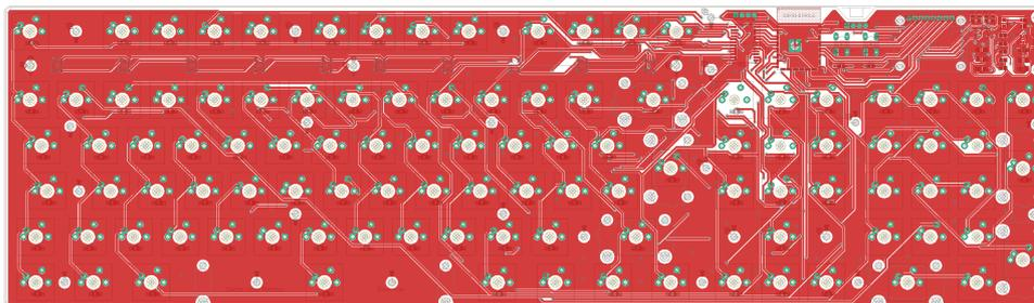
Figura 5.8: Imagen del plano de tierra superior de la PCB [10].
