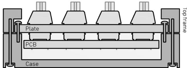
Figura 3.8: Montaje en carcasa [24]
