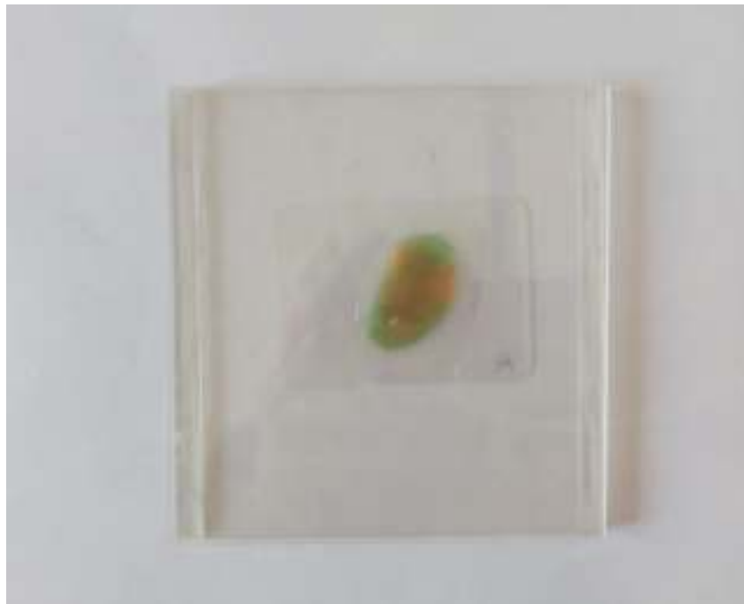
Figura 8. Colocación del chicle entre los dos portaobjetos para obtener una muestra de 1 mm de espesor.
