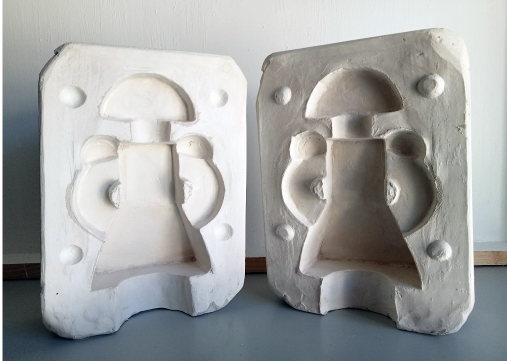
Castro, Luis., abril 2023. Molde de yeso abierto de la pieza superior o remate. Fotografía.
