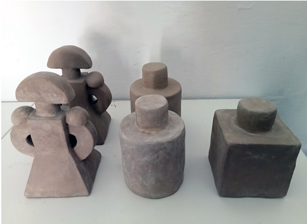
Castro, Luis., mayo de 2023. Piezas en colada de barro obtenidas mediante molde. Fotografía.
