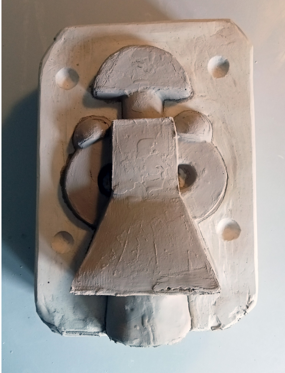
Castro, Luis., abril de 2023. Primera de las piezas obtenida en molde con colada de barro. Fotografía.
