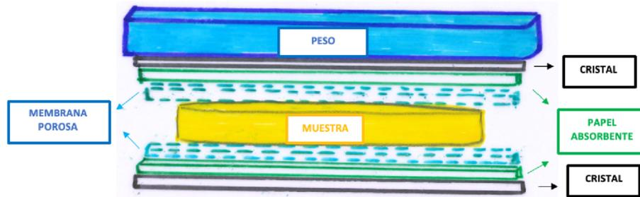
Figura 23. Ilustración que muestra los diferentes componentes utilizados para inducir la nanoestructuración de los sustitutos celulares y acelulares generados en la presente Tesis Doctoral.
