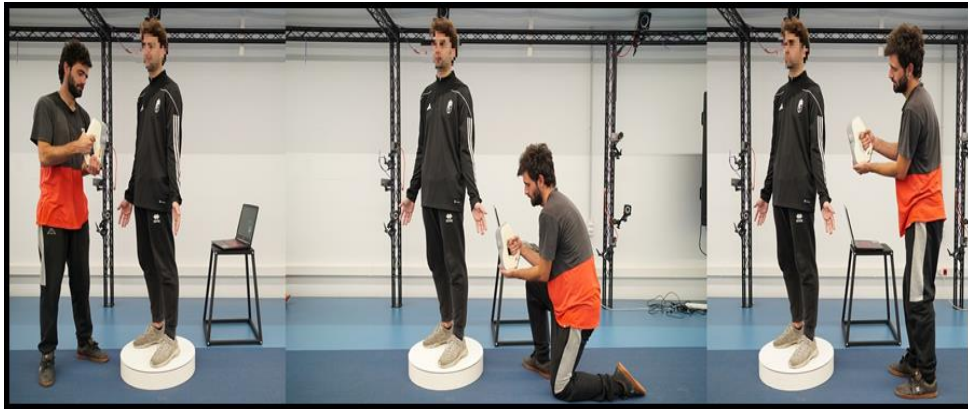
Figura 10. Proceso de escaneo del modelo para la creación del asesor virtual mediante escáner de luz estructurada ArtecEVA®
