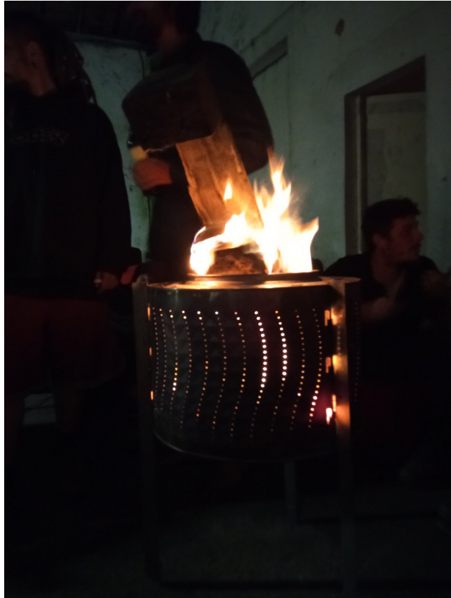
Ilustración 12: Ejemplo de DiY, convertir el tambor de una lavadora en una estufa.
