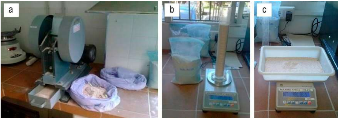
Figura 168. Molienda e hidratación de las muestras cocidas: a) molino de trituración utilizado; b) y c) pesaje de yeso y agua para la realización de las muestras con una relación agua/yeso de 0,6 en peso.
