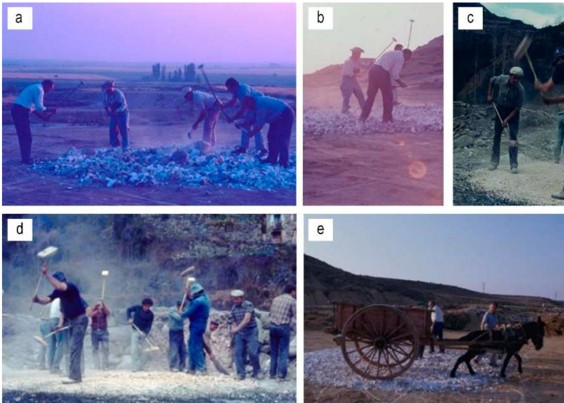
Figura 114. Evolución de los sistemas de triturado tradicionales: a) - c) Molienda tradicional en Lanaja (Huesca) en 1994, empleando la “algadera” (fotografía cortesía de E. Monesma Monge); d) y e) Molienda tradicional en San Juan de Plan (Huesca) en 1981 (fotografía cortesía de E. Monesma Monge).
