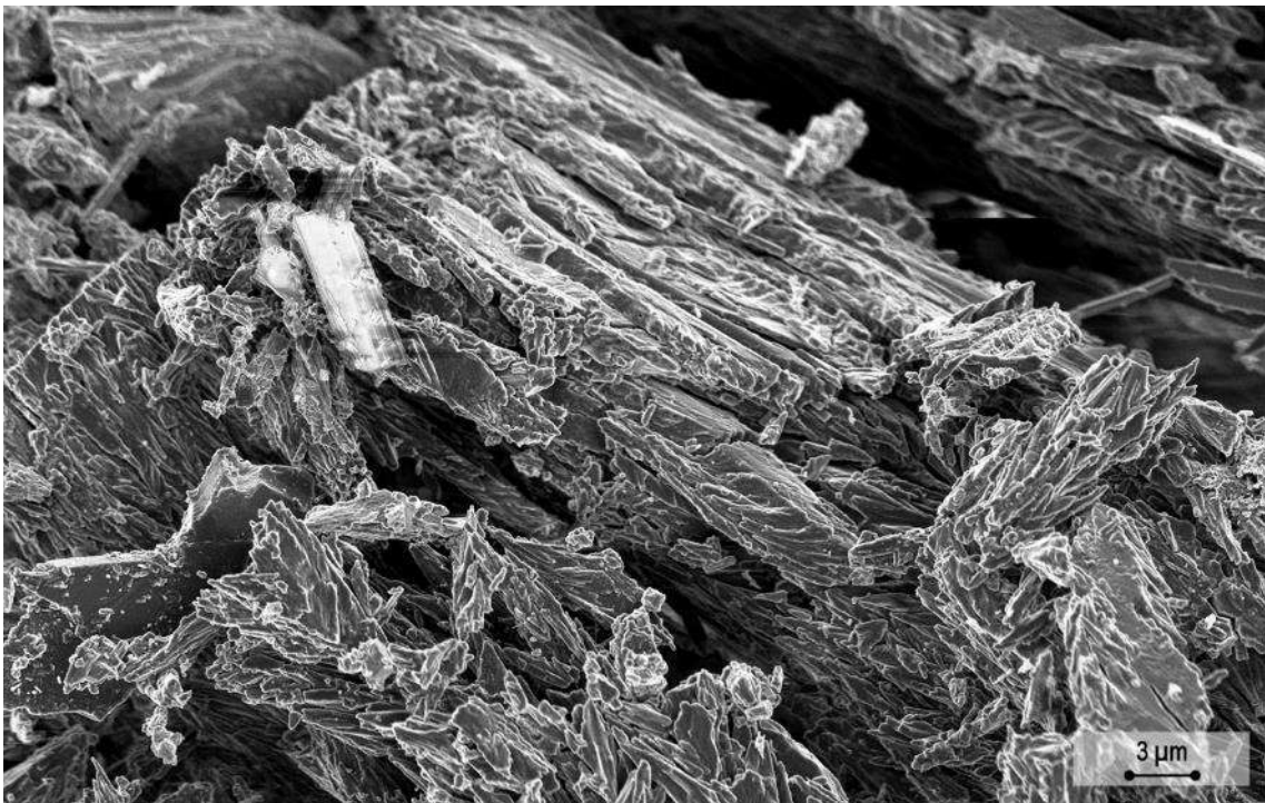
Figura-Material Complementario 43. Imágenes FESEM de las muestras de yeso tras la cocción en el horno de mufla a una temperatura de 800°C tras la hidratación.
