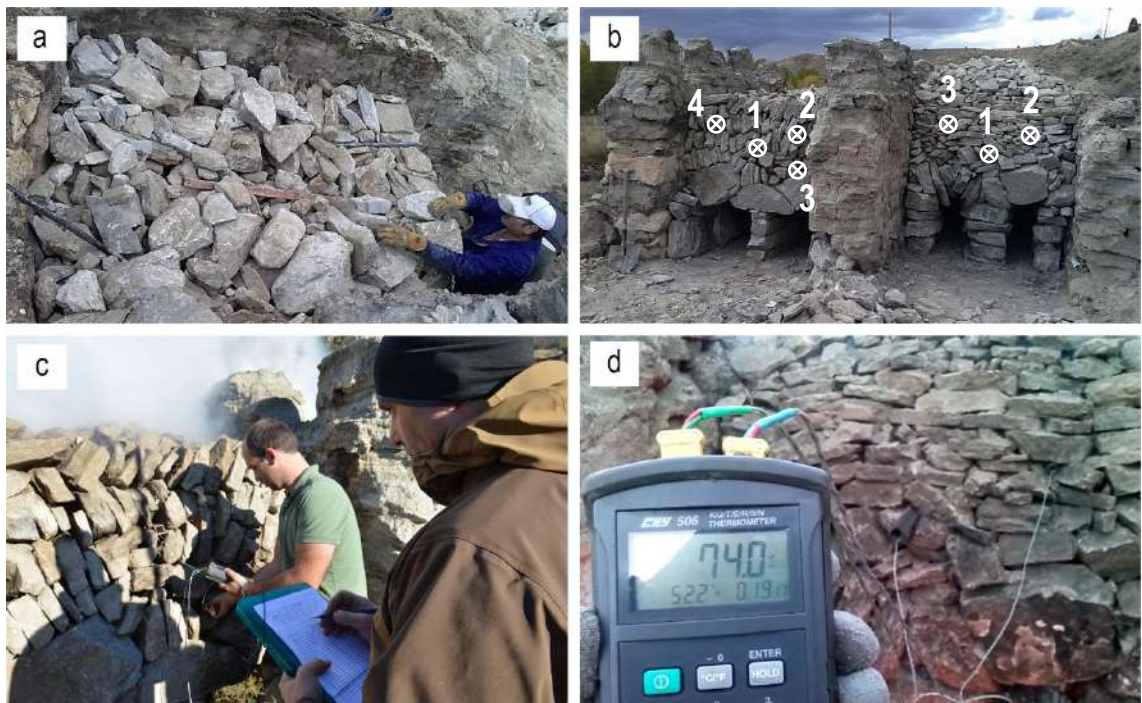
Figura 117. Sensores empleados para poder medir la temperatura de cocción en los hornos: a) colocación de tubos para poder introducir los sensores y medir la temperatura en algunos puntos del horno previo al encendido del fuego; b) hornos tradicionales (izquierda: horno de Navarrete; derecha: horno de Albarracín) antes de la cocción, mostrando la ubicación aproximada de las posiciones de los sensores (1, 2, 3, 4) para monitorizar la evolución de la temperatura durante las cocciones experimentales; c) toma de datos manual durante la cocción; d) Datalogger utilizado para medir las temperaturas. Fotografías del autor.
