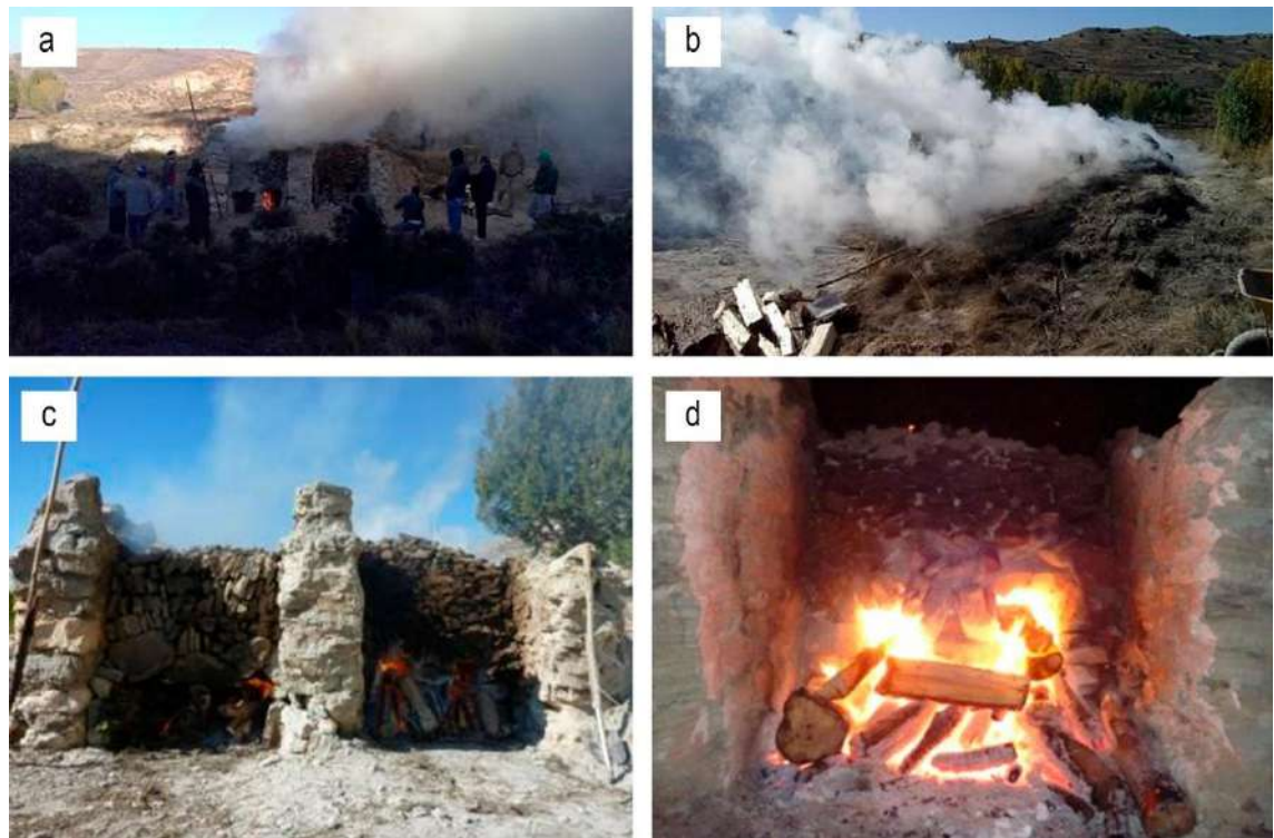
Figura 112. Distintas imágenes del proceso de cocción: a) y b) primeros momentos de la cocción, donde el humo se dice que “pesa” por la alta cantidad de vapor de agua que libera la piedra de yeso, por eso no asciende y se observa ese color blanquecino; c) momentos avanzados de la cocción (transcurridas unas 6 horas), donde sale mucho menos humo, menos denso y de un color más oscuro, debido a que las piedras de yeso ya no contienen vapor de agua; d) momento avanzado de la cocción en el que se aprecia el suministro de nuevo material de combustión (horno de la derecha: leña de árbol). Fotografías del autor.
