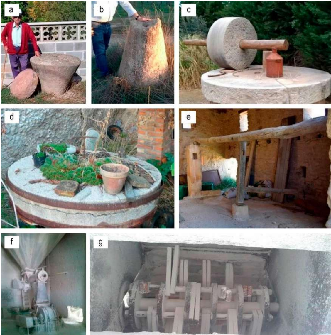
Figura 115. Evolución de los sistemas de triturado tradicionales: rulos y molinos utilizados para triturar yeso en los municipios de: a) Albelda (Huesca), b) Pozuelo (Zaragoza), c) San Esteban de Litera (Huesca), d) Alberuela de Tubo (Huesca) y e) La Fresneda (Teruel); f) trituradora mecánica actual (estanca) en Cuarte de Huerva (Zaragoza); g) trituradora mecánica actual en Marruecos (no estanca), que permite ver el mecanismo de trituración.
