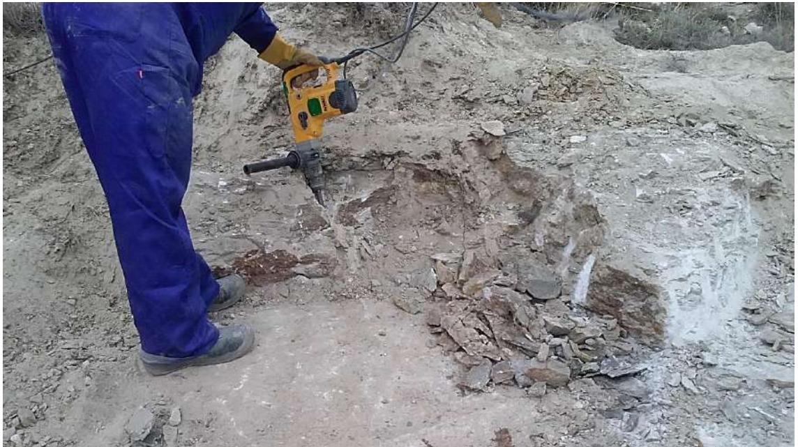
Figura 122. Utilización de un pistolete para la extracción de piedra de yeso. Se puede apreciar el efecto de la vibración de la máquina generando piedras de tamaño muy pequeño para su colocación en el horno. Fotografía del autor.
