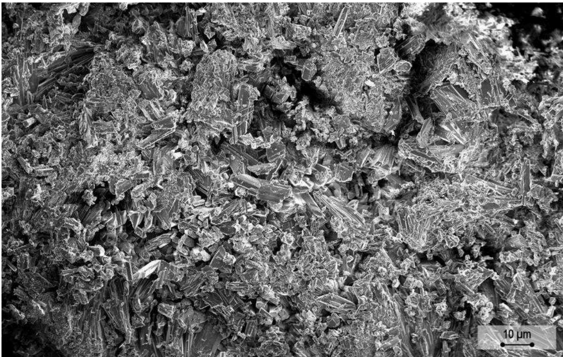
Figura-Material Complementario 36. Imágenes FESEM de las muestras de yeso tras la cocción en el horno de mufla a una temperatura de 250°C tras la hidratación.
