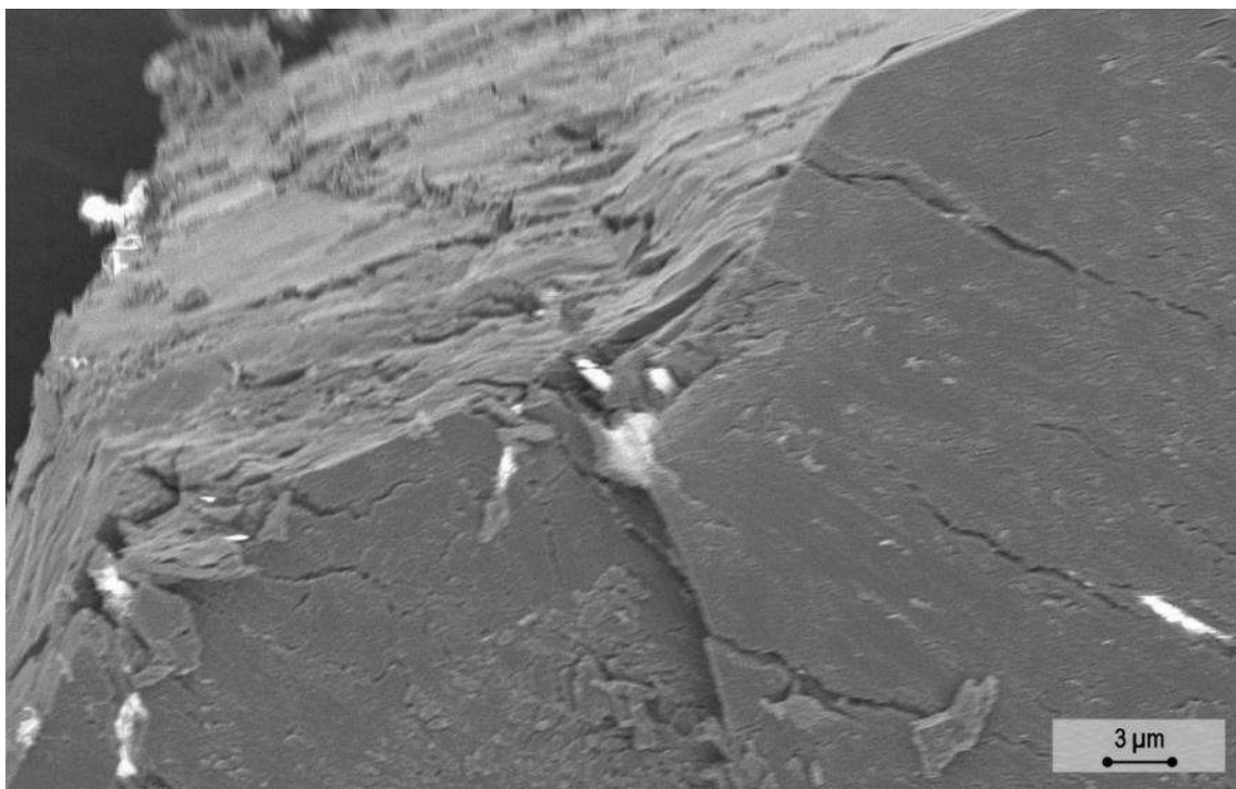
Figura-Material Complementario 12. Imágenes FESEM de las muestras de yeso tras la cocción en el horno de mufla a una temperatura de 100°C.
