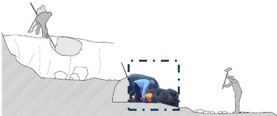
Figura 110. Fase: cocción del yeso en el hornete. Elaboración propia.
