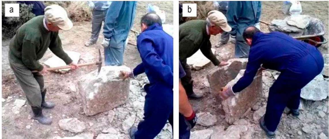
Figura 96. Trabajos realizados para extraer un bloque de yeso con la supervisión de dos antiguos yeseros (Pepe Rodrigo de 82 años y Esteban López de 88 años) en Navarrete del Río (Teruel): a) y b) separación de un bloque grande de yeso junto al plano generado por la estructura laminar de la roca usando un pico. Fotografías del autor.
