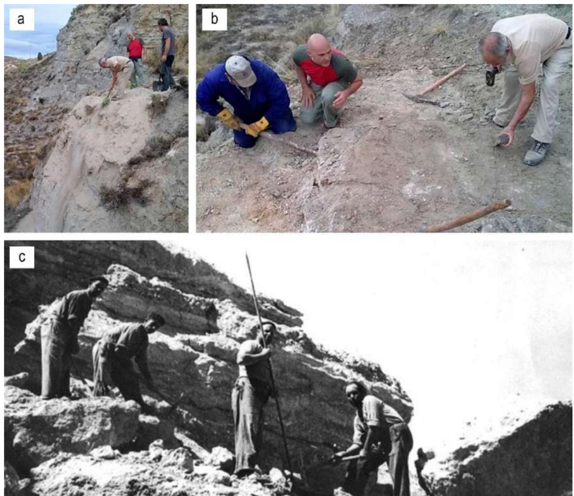
Figura 94. Trabajos realizados para extraer un bloque de yeso con la supervisión de dos antiguos yeseros (Pepe Rodrigo de 82 años y Esteban López de 88 años) en Navarrete del Río (Teruel): a) retirada del yeso arenizado y “soleado”; b) extracción de un bloque de yeso usando una barrena larga, pico y cuña (fotografías del autor); c) fotografía histórica que muestra una superficie minera de yeso en 1940 usando picos y una barra de excavación en una cantera familiar en San Esteban de Litera (Huesca) (fotografía cortesía del “Centro de Estudios Literanos” en Huesca).
