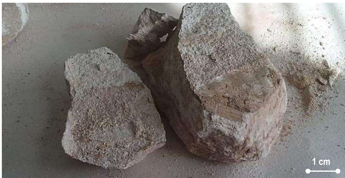
Figura 183. Muestra extraída del horno de Albarracín, zona media (AM), con un tono salmón, donde la corteza exterior se encontraba más adherida.
