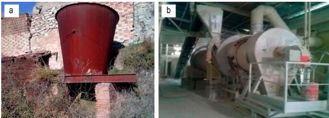
Figura 109. Hornos históricos abandonados: a) horno tipo F localizado en Albelda (Huesca); b) horno rotatorio cilíndrico en funcionamiento (tipo G) ubicado en Cuarte de Huerva (Zaragoza). Fotografías del autor
