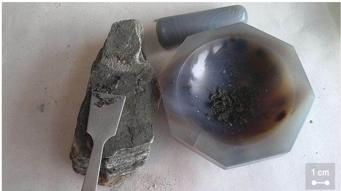
Figura 163. Proceso de extracción de los materiales arcillosos para la muestra CA. Fotografía del autor.
