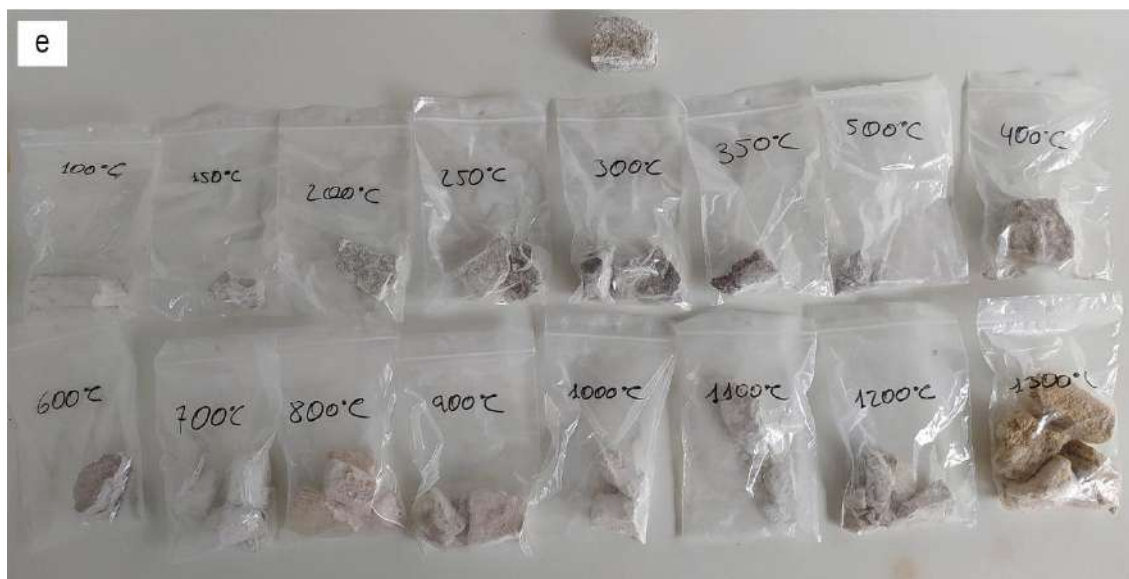
Figura 166. Obtención de las muestras cocidas a temperatura controlada en el horno de mufla: a) fragmentación de las piedras de yeso procedente de la cantera en Navarrete (Teruel) (la misma que la utilizada en los hornos tradicionales) en pequeñas piezas de 1,5 x 3 x 4 cm; b) colocación de la piedra de yeso en el horno de mufla; c) piedras de yeso durante el proceso de cocción a T controladas; d) extracción de piedra de yeso durante el proceso de cocción; e) muestras de yeso cocido a las temperaturas indicadas anteriormente.
