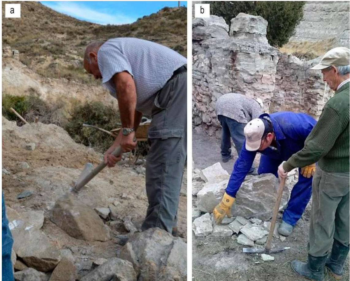
Figura 124. a) y b) Obtención de las piedras de yeso para cocer extraídas de la cantera, utilizando un pico para golpear las piedras por los planos de rotura. Fotografías del autor.
