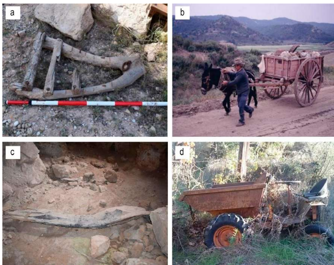
Figura 99. Sistemas de transporte localizado: a) restos de una antigua camilla (Borja, Zaragoza); b) carro cargado con rocas de yeso en Lanaja (Huesca) en 1994 (fotografía cortesía de E. Monesma Monge); c) parihuelas conservadas en Villalba Alta (Teruel); y d) volquete mecánico en una de las yeserías de San Esteban de Litera (Huesca). Fotografías (a), (c) y (d) del autor.
