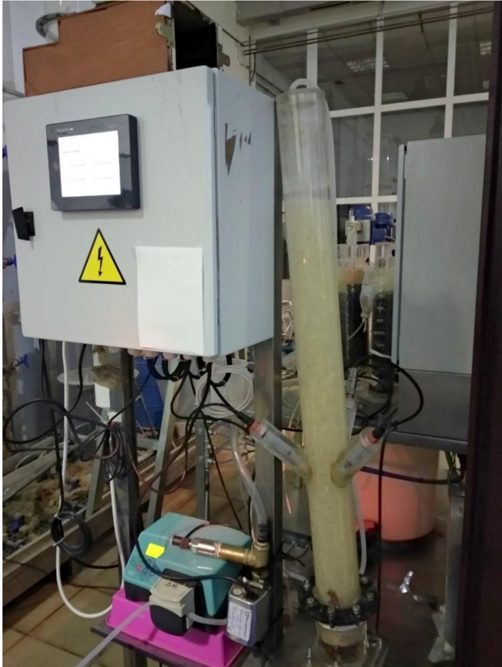
Imagen 1: Planta piloto de tecnología granular aeróbica
